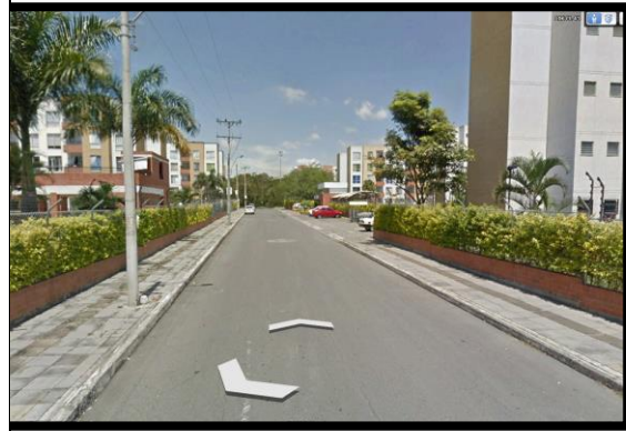
Figura 60 Aceras de entre 90 cm y 150 cm de ancho, con postes de luminaria en medio Fuente Google Earth.
