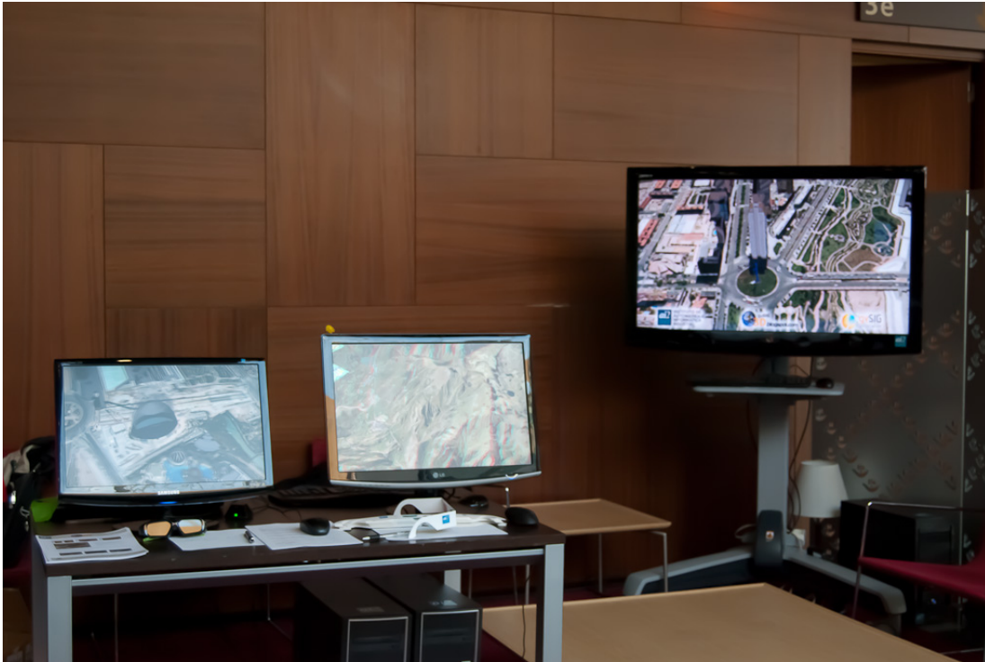
Figura 6.12: Equipos utilizados en la prueba, todos ellos con la opción de pantalla completa activada, para aumentar la sensación de inmersión. De izquierda a derecha: sistema quadbuffer , anaglifos y pantalla autoestereoscópica con filtro lenticular.
