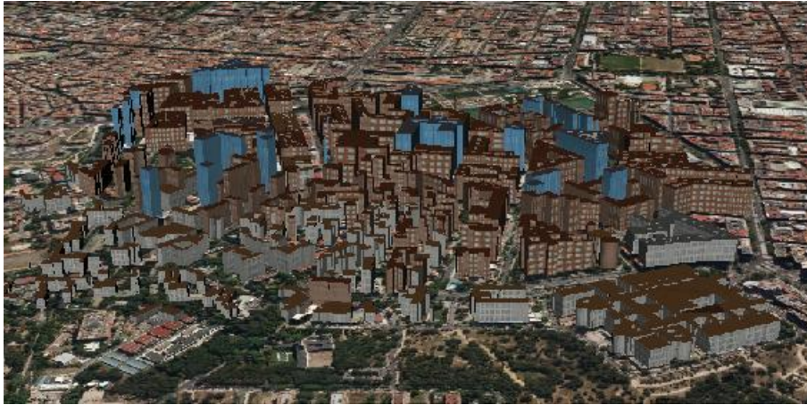
Figura 8.3: Conversión de un modelo urbano en formato no estándar al modelo cityGML, soportado por gvSIG 3D
