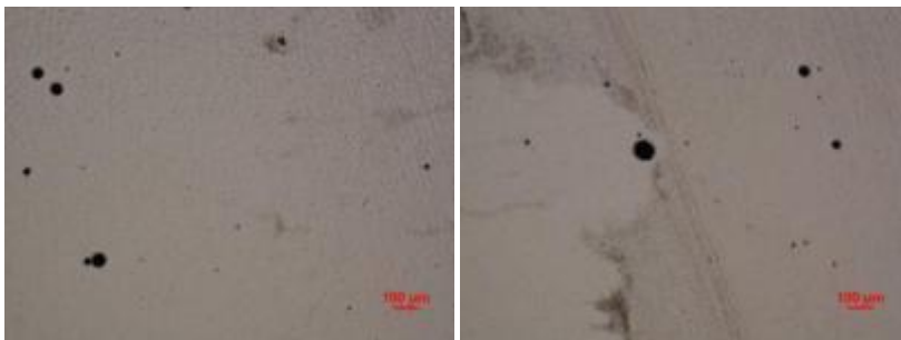
Metalografías de la probeta 6 a 50 aumentos
