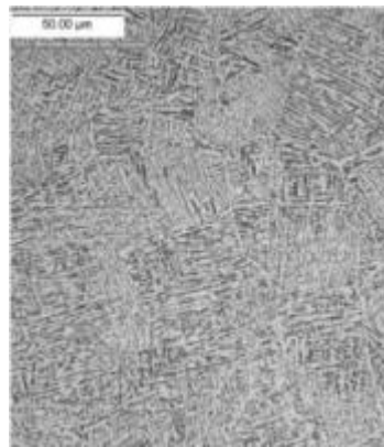
Fig. 14. Microestructura del \text{Ti6Al4V} ELI obtenida por EBM.
