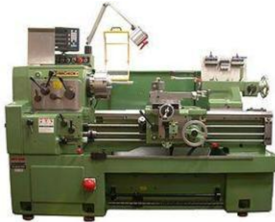
Fig. 47 Torno utilizado para el torneado de las probetas de tracción
