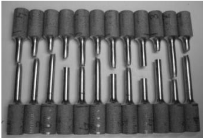
Fig. 54 Probetas de tracción tras su ensayo
