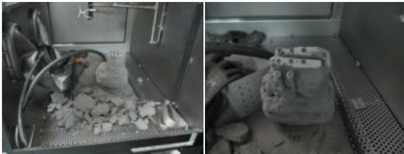
Fig. 44 Proceso de eliminación del polvo semi-sinterizado
