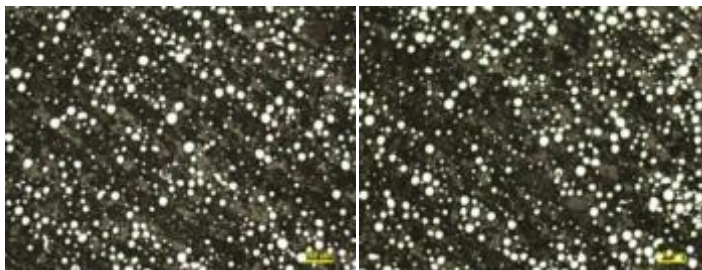
Fig. 25 y 26 Metalografías del polvo a 100 aumentos.
