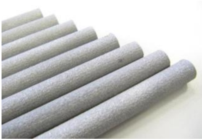
Fig. 34 barra fabricadas mediante EBM en Ti6Al4V ELI
