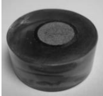
Fig. 24 Polvo embutido, pulido y metalizado
