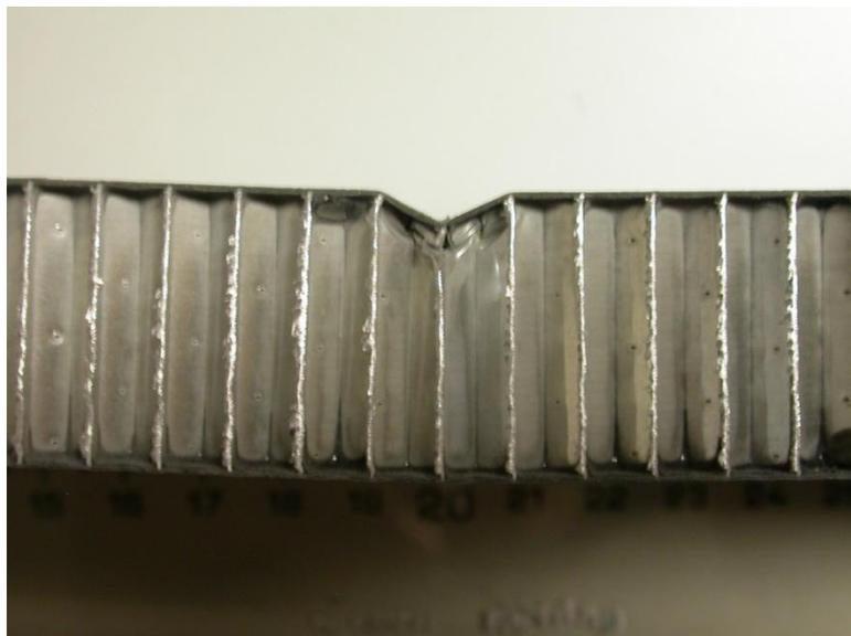
Figura 4.6. Fallo por indentación sección transversal
