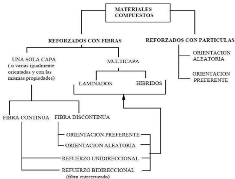
Figura 2.5. Clasificación materiales compuestos.
