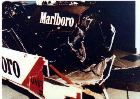
Figura 1.10. Chasis McLaren MP4 / 1 tras colisión
