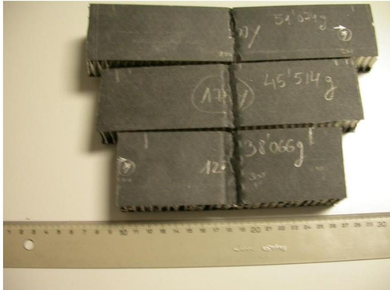
Figura 4.5. Fallo por indentación sección longitudinal
