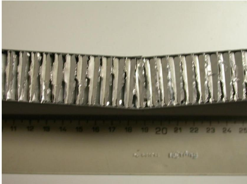
Figura 4.7. Fallo por fractura piel sección transversal
