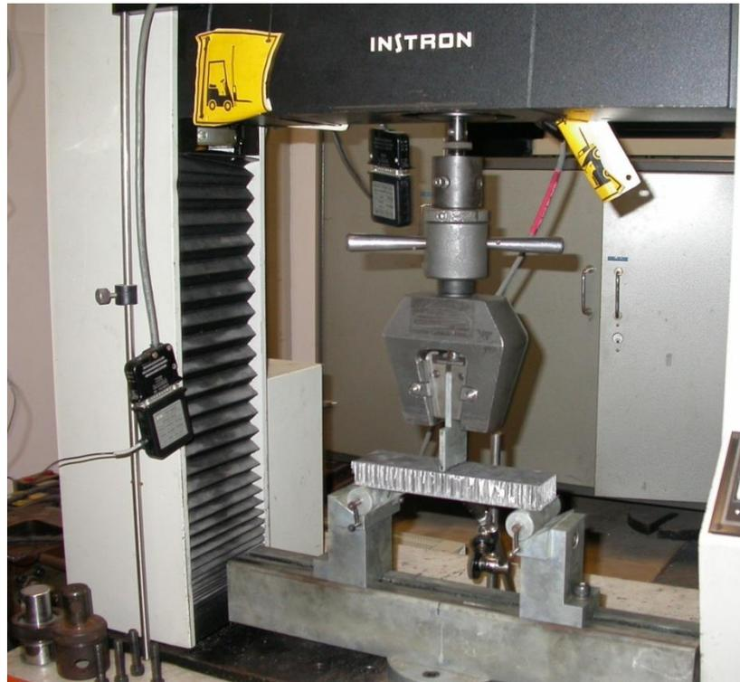
Figura 4.10. Ensayo de flexión
