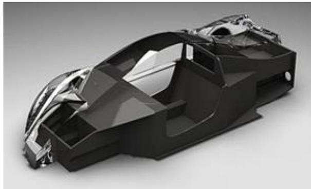
Figura 1.1. Estructura monocasco de un vehículo deportivo, realizada con paneles sándwich.
