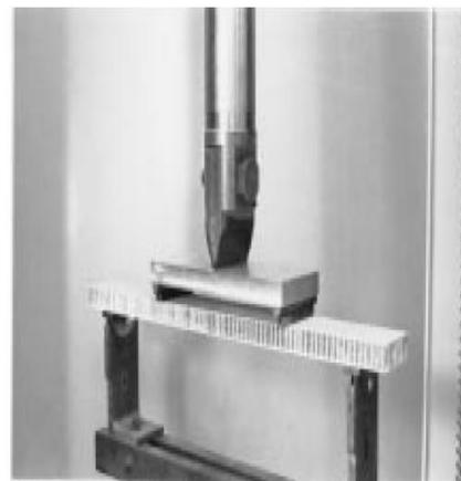
Figura 3.5. Configuración ensayo flexión
