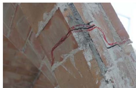
Figura 5. (a)-Evolución de las reacciones verticales en las bases de apoyo S1, S2, S3y S4. (b)- Rotura del arco que arranca en S2 hacia la base de apoyo S3.
