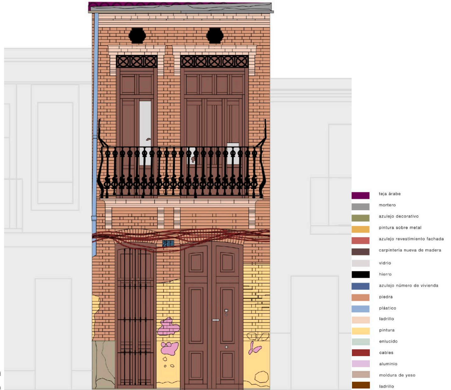
Figura 53 | Mapeado materialidad fachada calle Progreso, 211 Fuente: elaboración propia
