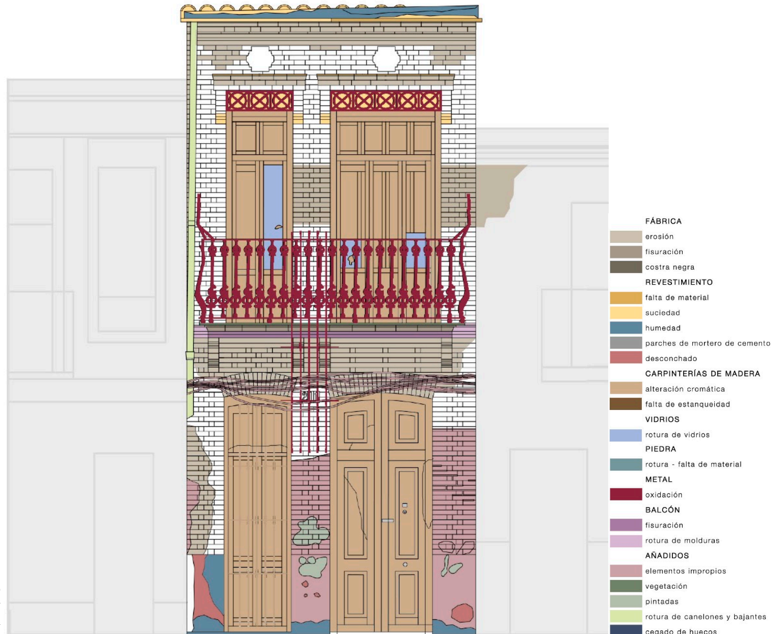
Figura 65 | Mapeado patología material fachada calle Progreso, 211 Fuente: elaboración propia
