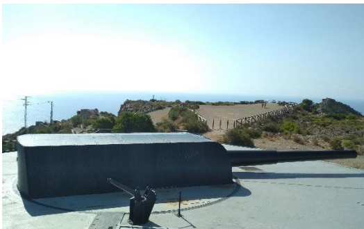
Figura 39: Se puede observar la plataforma que permite girar al cañón 360°. (Imagen propia)
