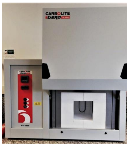
Figura 45. Horno eléctrico convencional (Carbolite Cero 30-3000).
