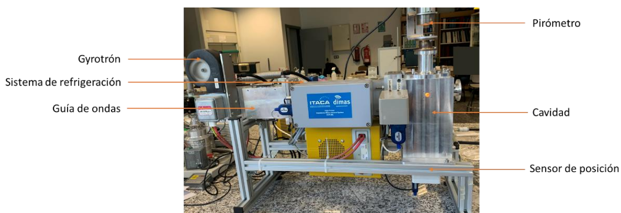
Figura 47. Microondas fabricado y diseñado por ITACA e ITM.
