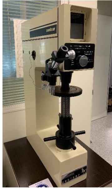
Figura 34. Durómetro (Model HD9-45 Superficial Rockwell & Vickers Optical Hardness Tester, CENITUR) que aplica una carga de 15 kg.
