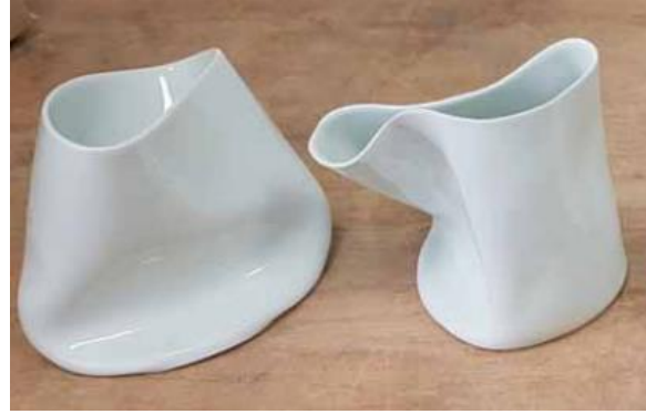
Figura 13. Colapso de las tazas sobre sí mismas debido a una temperatura de cocción demasiado alta causada por demasiadas impurezas (Horwat, 2020).
