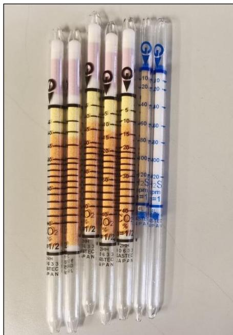
Figura 35: Análisis del biogás: tubos de absorción
