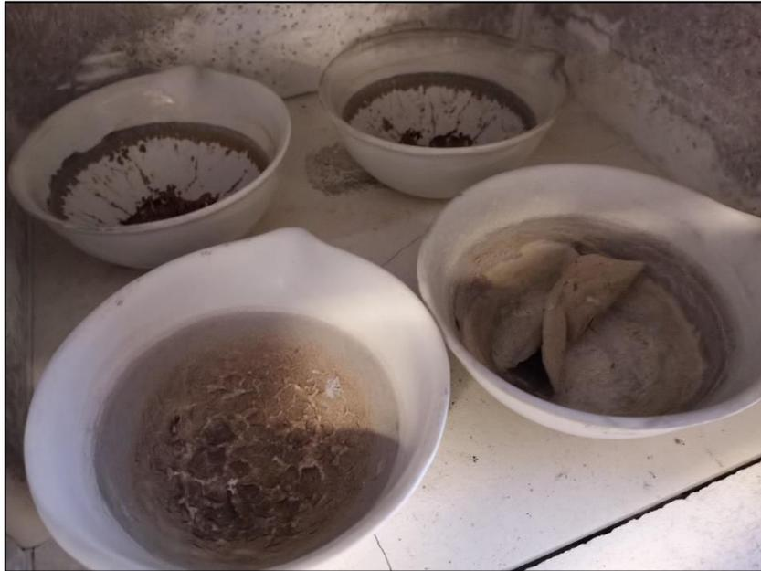
**Figura 8: Residuo remanente tras la calcinación en mufla. Determinación de sólidos en suspensión volátiles (SV) del fango.**
