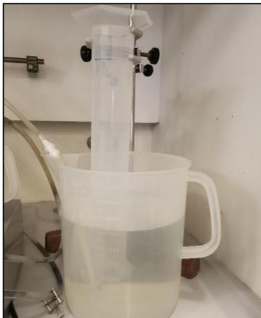
**Figura 22: Gasómetro de la planta a escala laboratorio**
