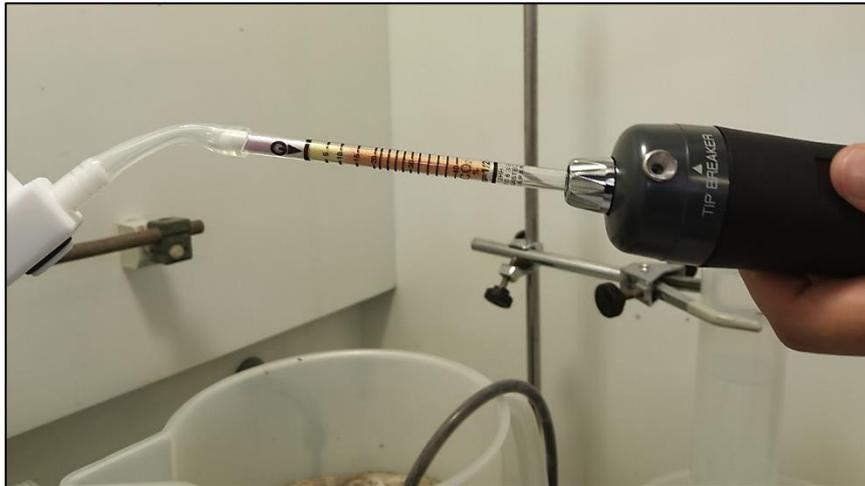
**Figura 26: Medición de la concentración de CO<sub>2</sub> en el biogás**
