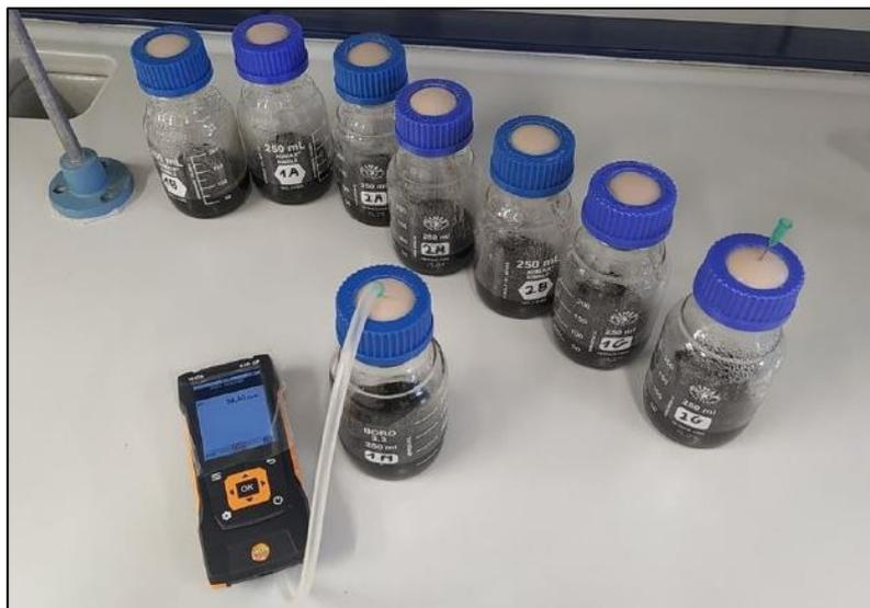
**Figura 15: Medidas de presión de los test PBM**
