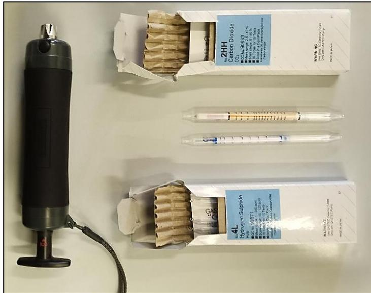
**Figura 25: Bomba GASTEC y tubos de medición**
