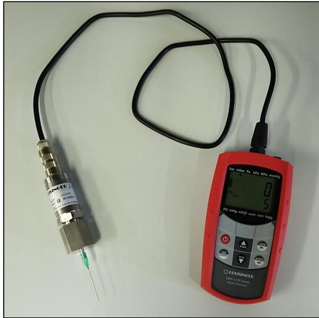
**Figura 19: Transductor de presión *GREISINGER GMH S100 Series*, con sensor de 1 bar y adaptador para aguja hipodérmica.**
