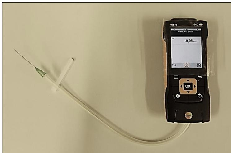
**Figura 18: Medidor de presión *Testo 440 dP***
