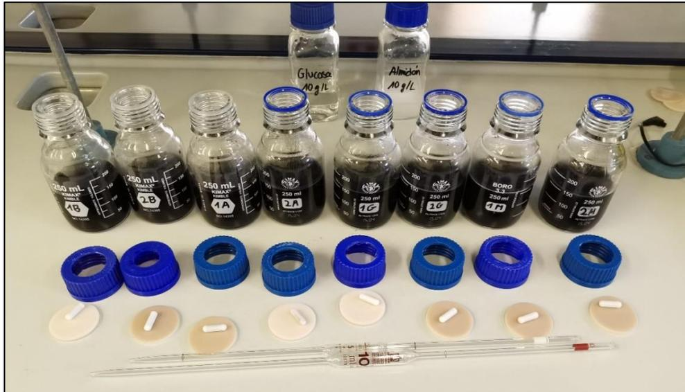
**Figura 13: Microdigestores del ensayo PBM-1 tras su dosificación**
