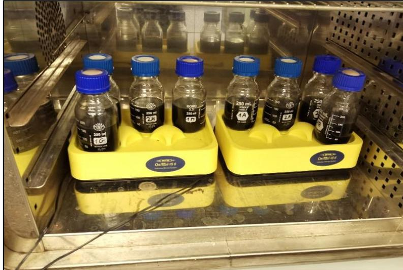
**Figura 14: Estufa de incubación con los frascos del ensayo PBM.**
