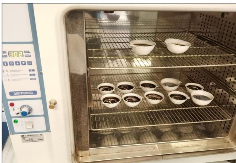
**Figura 7: Residuo seco remanente tras la evaporación, para la determinación de sólidos en suspensión totales (ST) del fango.**
