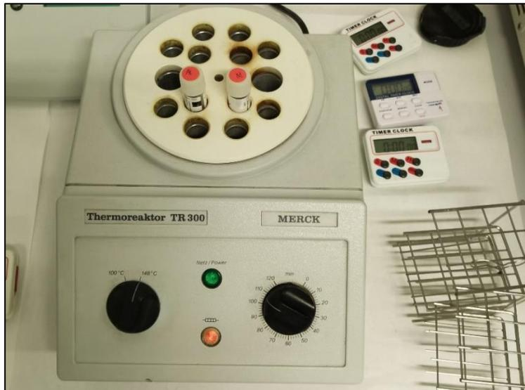
**Figura 10: Termorreactor empleado en la determinación de la DQO**
