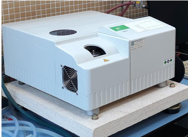
Figura IV- 18. Calorímetro diferencial de barrido (DSC) modelo Mettler-Toledo 821.
