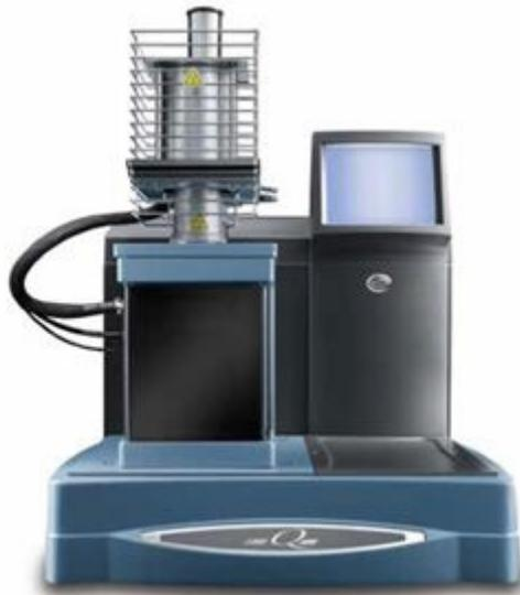
Figura IV- 22. Analizador Termomecánico TA Instruments, modelo Q400 [269].
