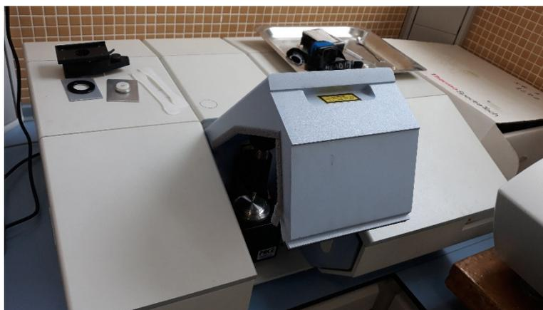
Figura IV- 26 Espectrofotómetro de Infrarrojo FTIR.
