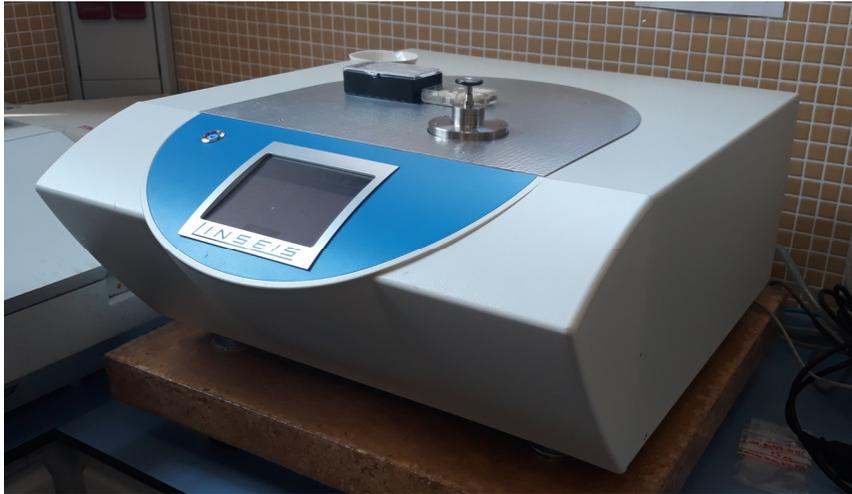
Figura IV- 20. Analizador termogravimétrico Linseis Modelo TG-PT1000
