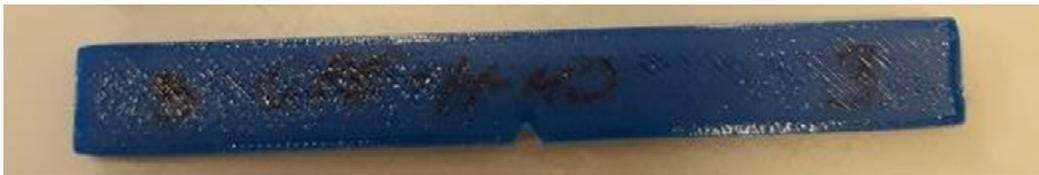
Figura IV- 16 Imagen de una muestra de CPE para el ensayo Charpy con muesca mecánica.
