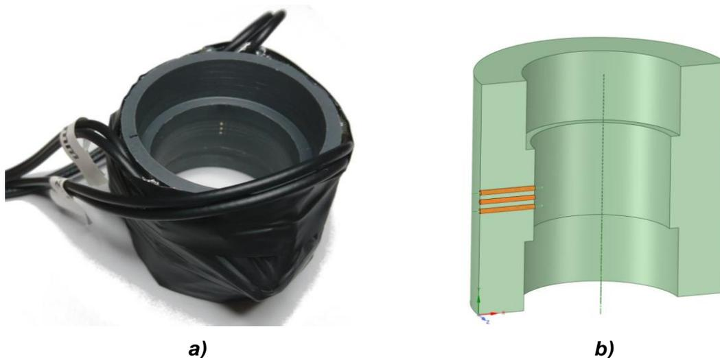
**Figura 2. Sonda de conductancia en a) el aspecto real y en b) el corte longitudinal en el que se pueden apreciar la colocación de los tres electrodos.**
