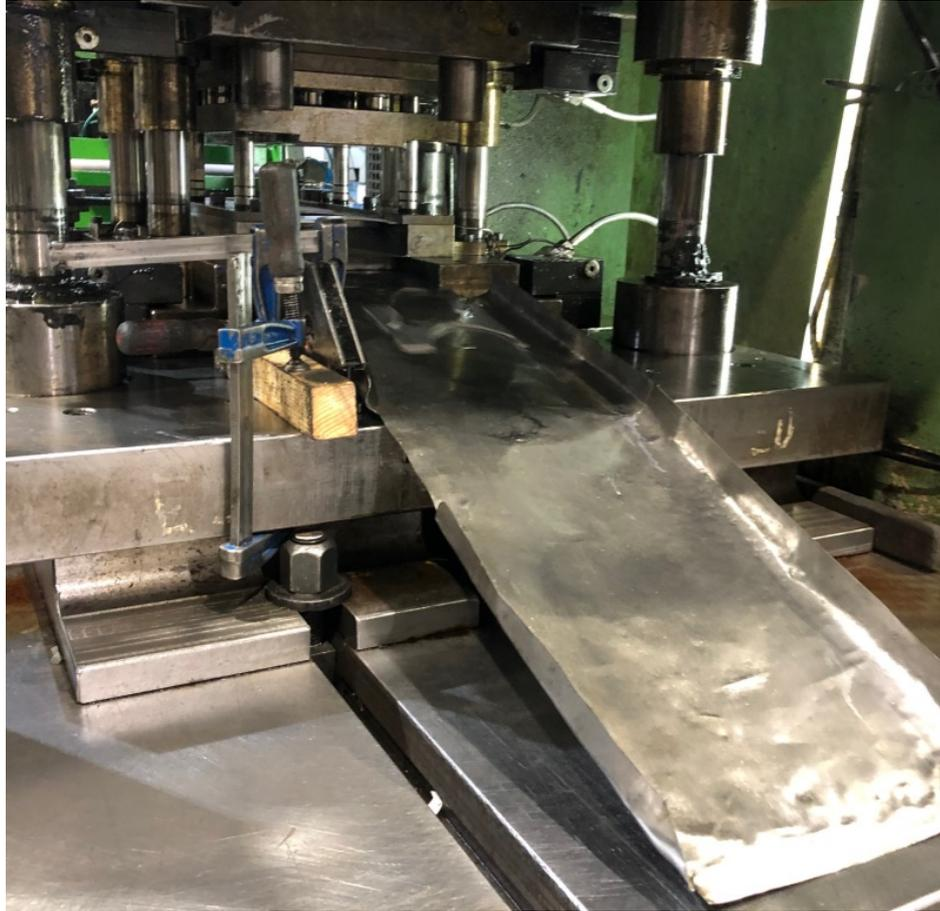
*Figura 19. Rampa de salida de pieza.*
