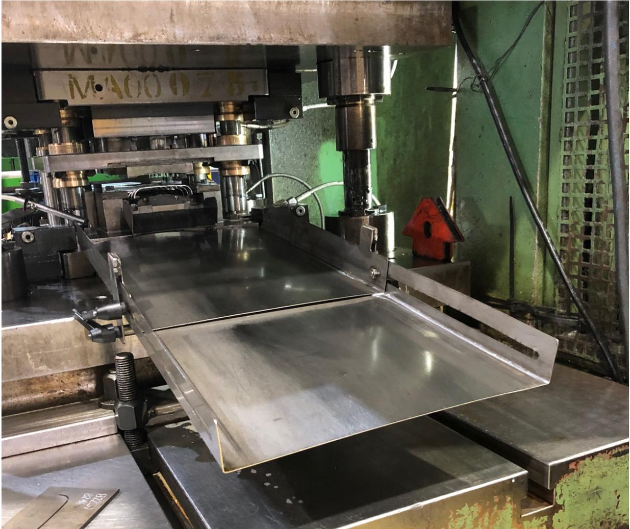
*Figura 24. Nueva rampa de salida de pieza.*
