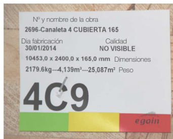
Imagen 2.33 Nomenclatura de un panel. - Prontuario Técnico para la Construcción con Paneles de Madera Contralaminados EGO CLT. EGOIN
