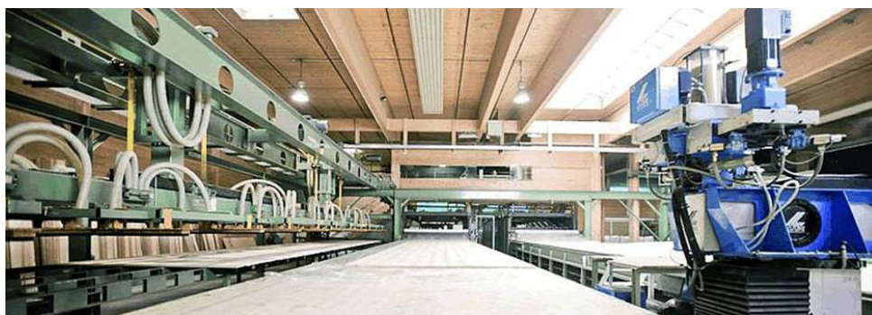
Imágenes 2.16 y 2.17 Procesos de pegado y prensado - TFM El tablero contralaminado, Umberto Viotto
