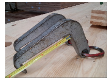
Imagen 2.35 Pinzas con forma en C. - Prontuario Técnico para la Construcción con Paneles de Madera Contralaminados EGO CLT. EGOIN
