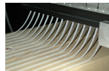
Imagen 2.14 Aplicación de PUR - https://www.jowat.com/es-CL/aplicaciones/industria-maderera/materiales-con-base-de-madera/laminada/
