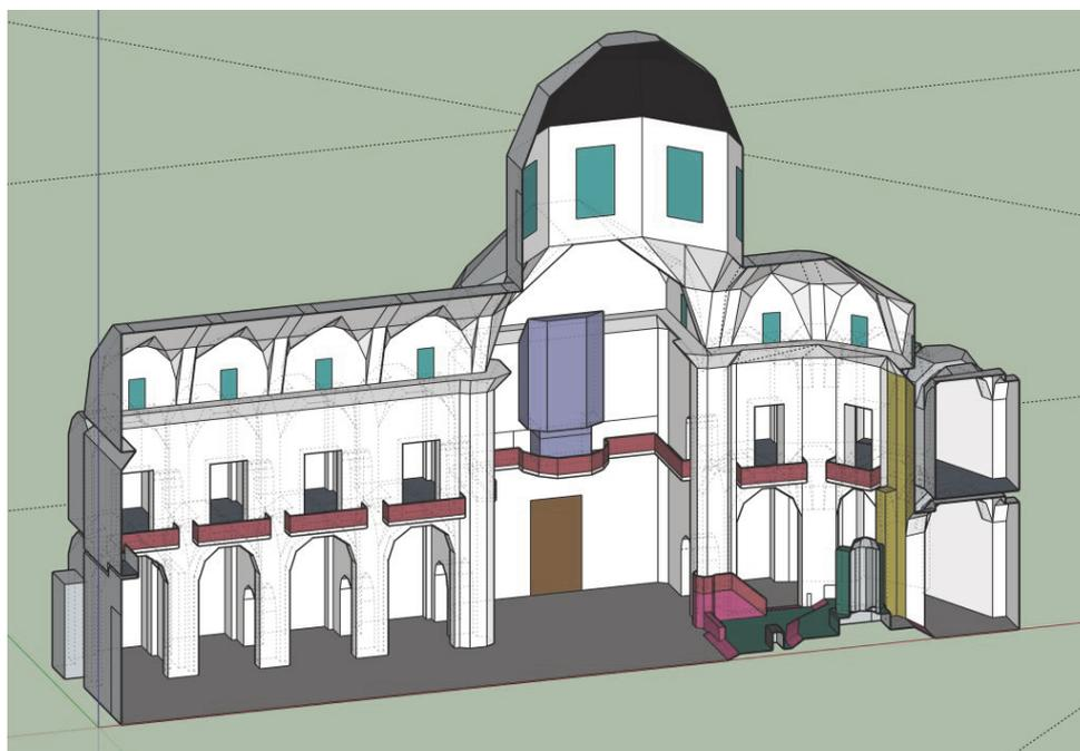
Figura 2 – Modelo de la Basílica para la simulación acústica con los materiales diferenciados por colores.
