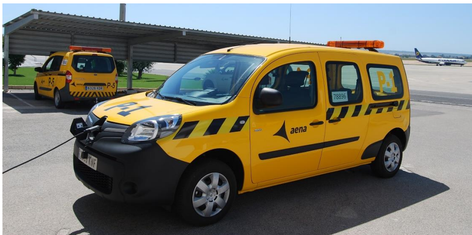
Imagen 2. Vehículo eléctrico 'sígame' del aeropuerto de Alicante-Elche, en carga
