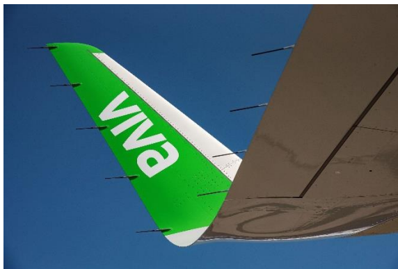
Imagen 2. Detalle del sharklet de un A321neo de Viva Aerobus (fuente: airbus.com )
