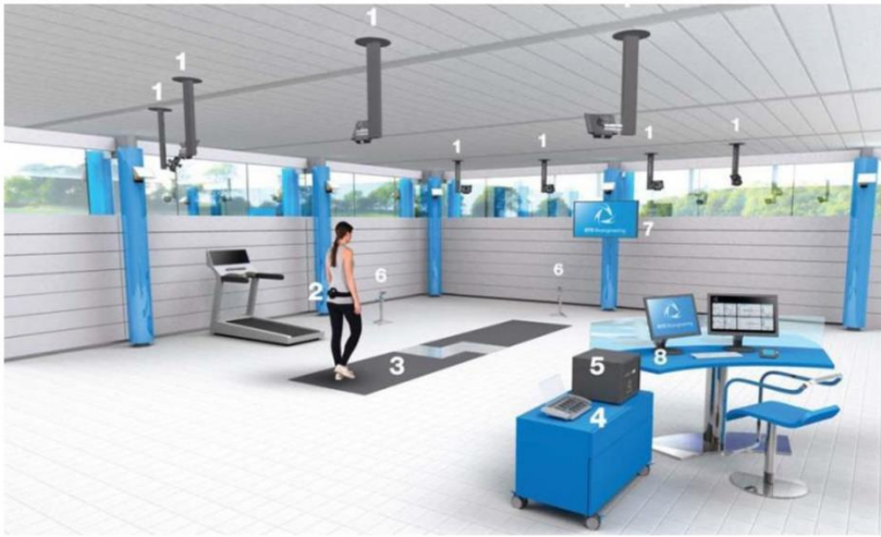
Figura 17. Configuración de BTS GaitLab. (1) cámaras de video infrarrojas; (2) sensor inercial; (3) pasarela de medición (plataformas de fuerza); (4) EMG inalámbrico; (5) estación de trabajo; (6) sistema de grabación de video; (7) pantalla de TV; (8) estación de control.
