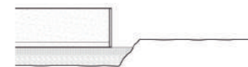
4. Vertido de un hormigón pobre de limpieza, colocación de las armaduras y hormigonado de la losa.
