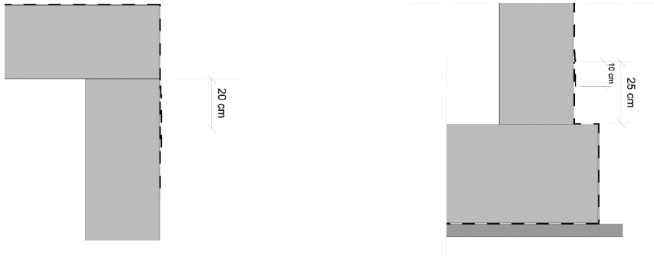
Figura 32. Detalle solape esteras de bentonita.
