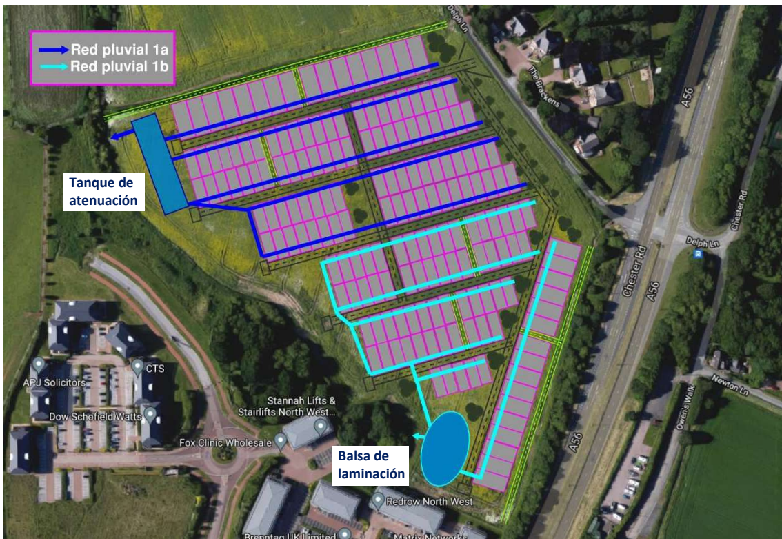
Figura 12. Representación esquemática de la red de aguas pluviales 1 (adaptación de Google Earth).
