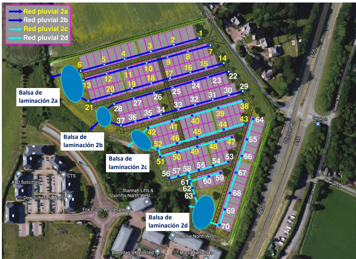
Figura 16. Representación esquemática de la red de aguas pluviales 2 (adaptación de Google Earth).
