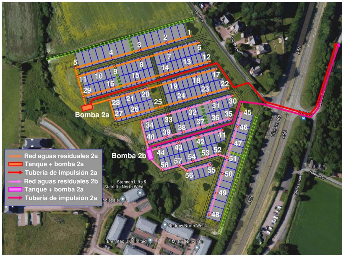
Figura 20. Representación esquemática de la red de aguas residuales 2 (adaptación de Google Earth).
