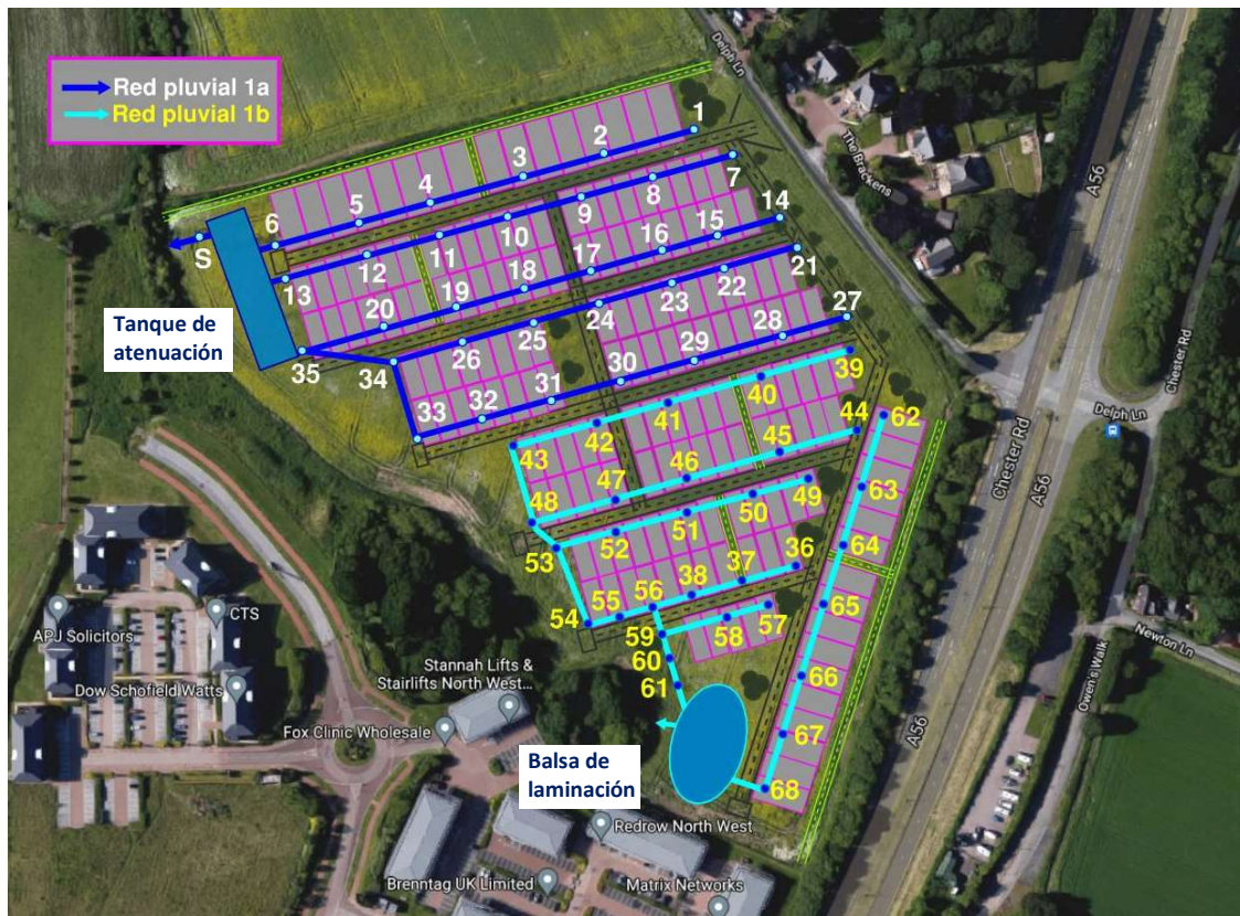
Figura 15. Representación esquemática de la red de aguas pluviales 1 (adaptación de Google Earth).
