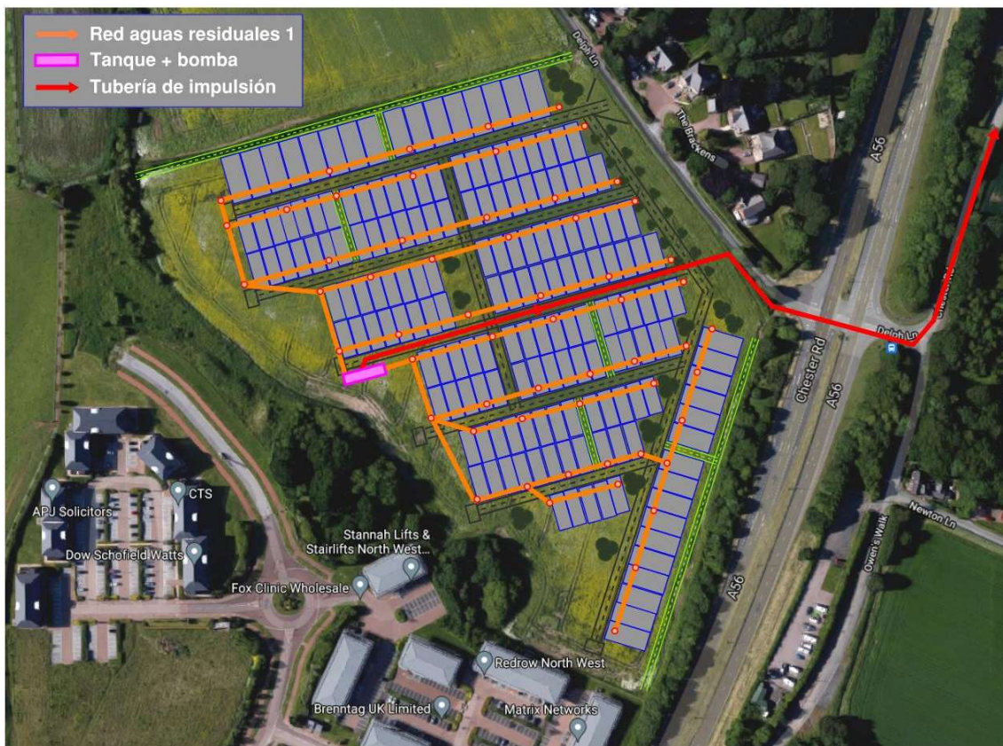
Figura 17. Representación esquemática de la red de aguas residuales 1 (adaptación de Google Earth).
