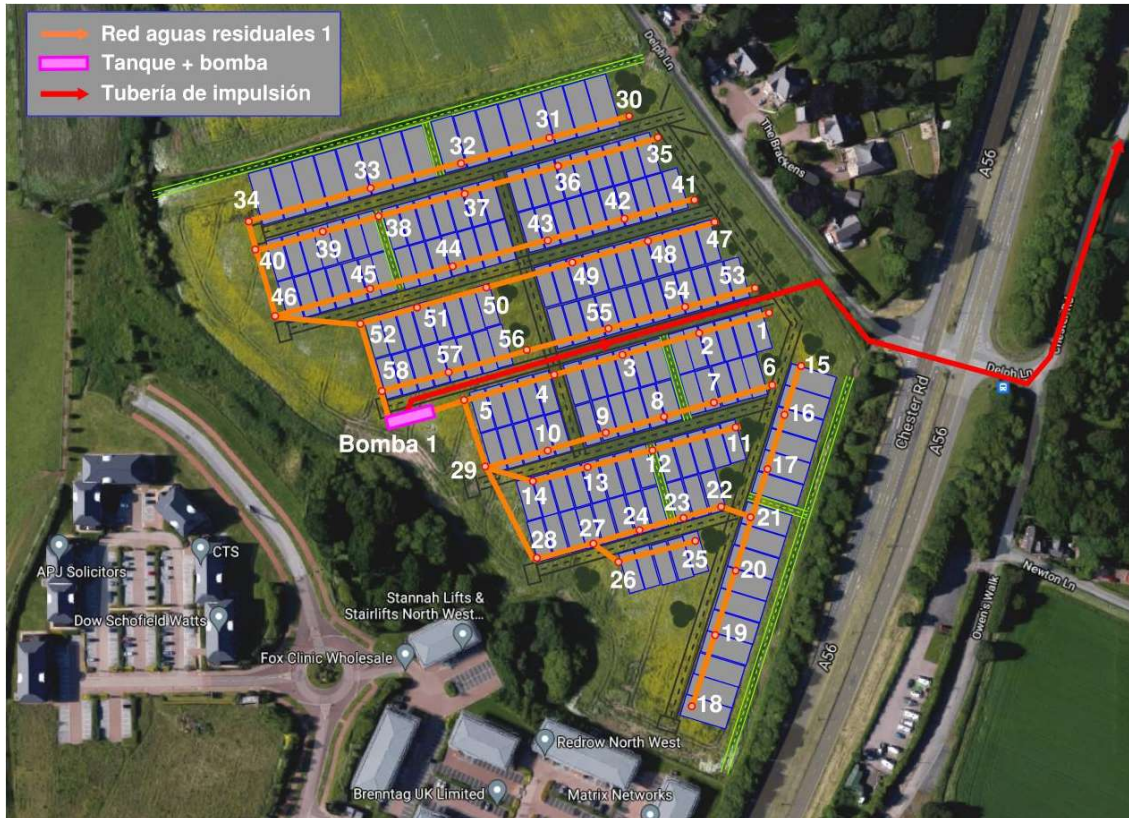
Figura 19. Representación esquemática de la red de aguas residuales 1 (adaptación de Google Earth).
