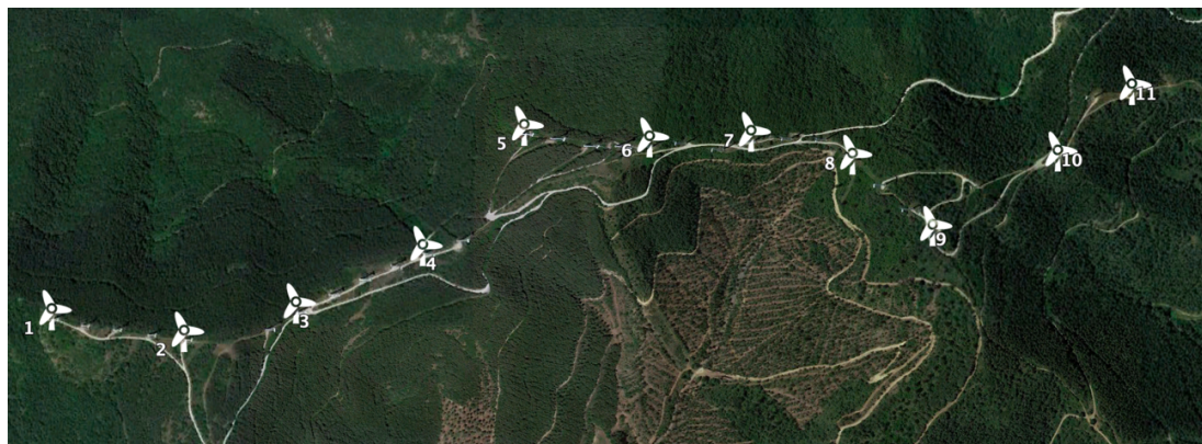
Figura 29 Alternativa de diseño B en el parque de Villanueva. (Fuente: Google Earth con adaptación propia)
