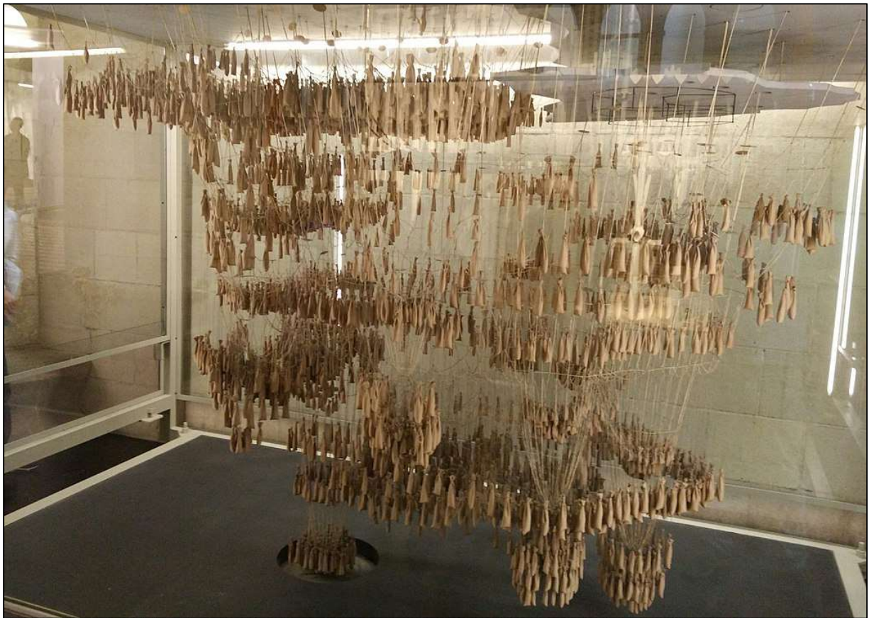
Ilustración 4: MAQUETA FUNICULAR DE LA CRIPTA DE LA COLONIA GÜELL - Antoni Gaudí– Fuente: Wikipedia, (2022) [ONLINE]. Available at: https://es.wikipedia.org/wiki/Maqueta_funicular_de_la_cripta_de_la_colonia_G%C3%BCell
