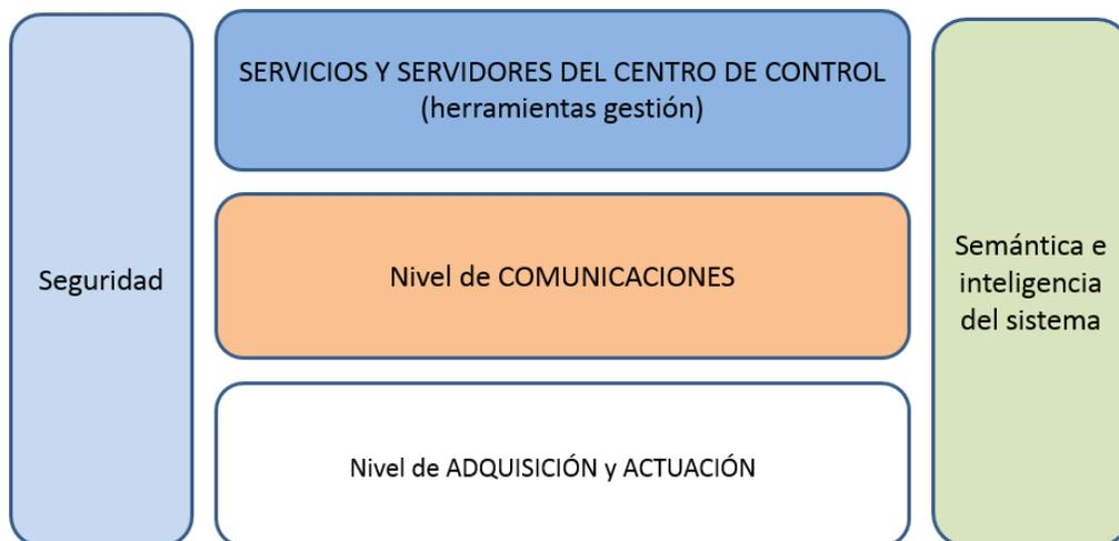
Figura 4.2 Esquema de capas y niveles de la arquitectura del sistema
