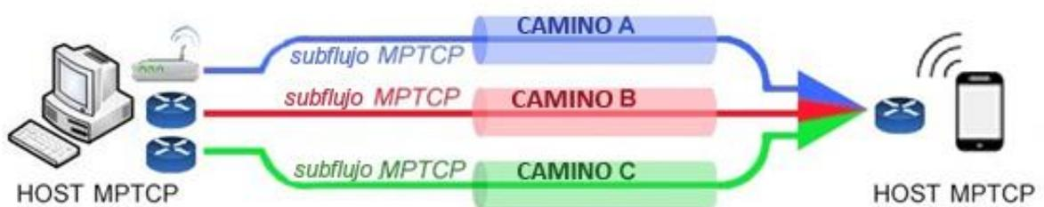
**Figura 3.1** Ejemplo de una conexión MPTCP compuesta por 3 subflujos de datos.
