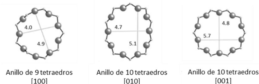
**Figura 4.3. Tamaño y apertura de poro de cada uno de los canales que forman la estructura zeolítica de la zeolita ITQ-13 (Å).**
