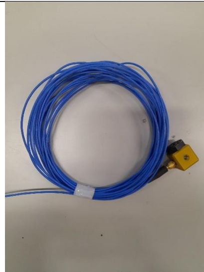
Ilustración 16: Acelerómetro piezoeléctrico. Fuente: Elaboración propia
