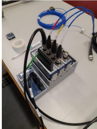
Ilustración 24: Sistema de adquisición de datos National Instruments NI cDAQ-9174.
