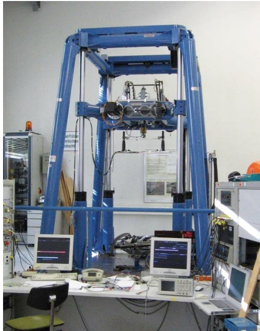
Ilustración 10: Banco de pruebas para pantógrafos DB.
