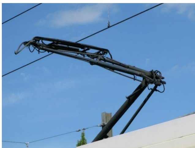
Ilustración 1: Pantógrafo en contacto con catenaria.
