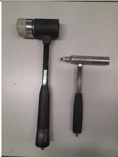
Ilustración 15: Martillos de impulso instrumentados. Fuente: Elaboración propia
