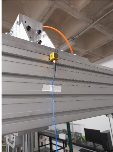
Ilustración 26: Pociónamiento del acelerómetro en los puntos de medida (punto 13). Fuente: Elaboración propia
