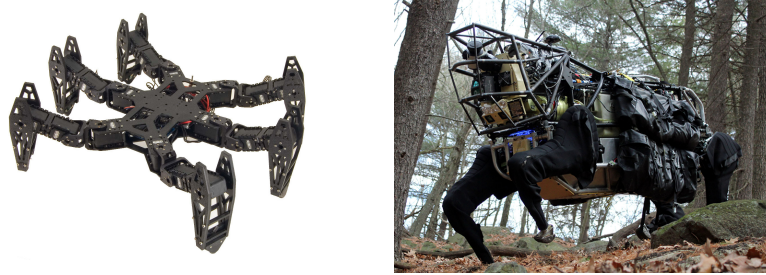
Figura 2.6: Hexápodo PhantomX AX (Trossen Robotics) y cuadrúpedo AlphaDog LS3 (Boston Dynamics)
