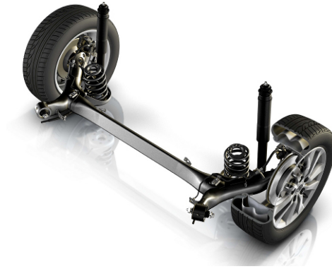
Figura 4.6: Eje trasero con barra de torsión (Toyota Auris)
