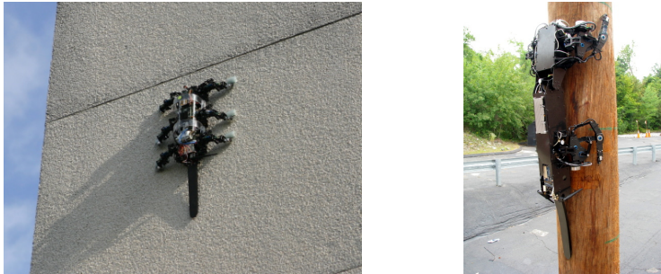
Figura 2.7: Robots trepadores RiSE V2 (hexápodo) y RiSE V3 (cuadrúpedo) de Boston Dynamics
