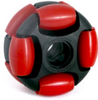
Figura 2.4: Rueda omnidireccional doble de Rotacaster. Las ruedas locas (de color rojo) permiten a la rueda principal deslizarse lateralmente
