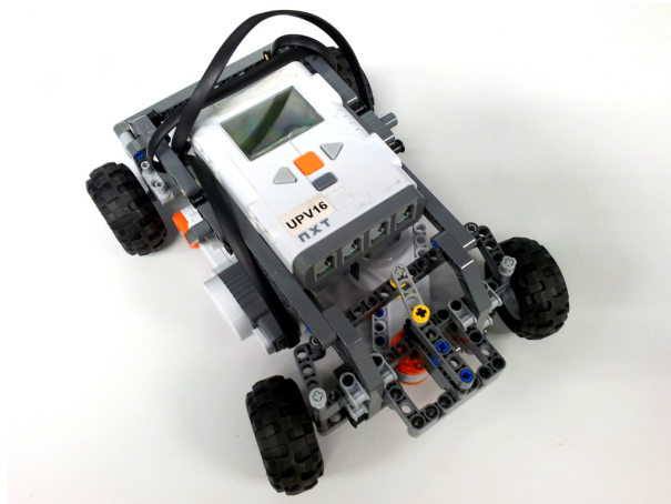
Figura 6.1: Robot de Lego NXT con configuración Ackerman empleado (dimensiones: radio de las ruedas r = 2,8 cm y distancia entre ejes l = 16,7 cm)
