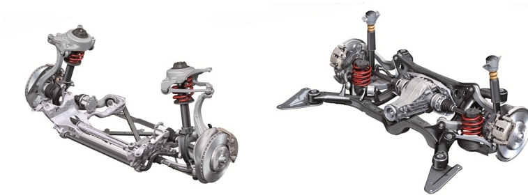
Figura 4.15: Suspensión delantera de 5 brazos y trasera tropezoidal de propulsión (Audi A4, 2010)
