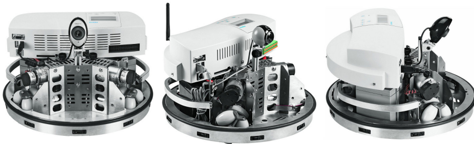
Figura 2.5: Robot omnidireccional Robotino fabricado por Festo
