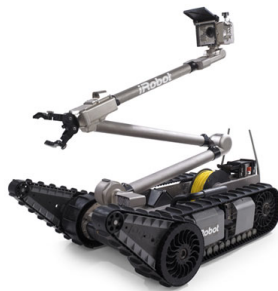
Figura 2.2: Robot PackBot con locomoción de tipo oruga desarrollado por iRobot
