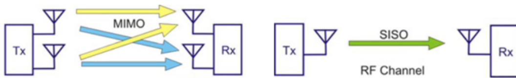
Imagen 36. Fundamentos del MIMO/SISO. (Chatterjee, 2012)
