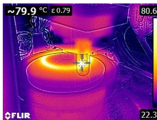
Ilustración 29. Imagen térmica de la máquina a altos rpm.
