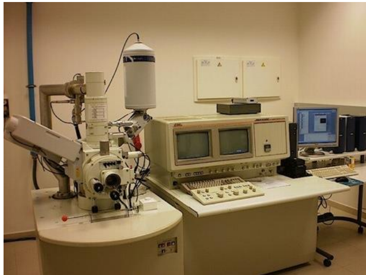
Ilustración 34. Microscopio SEM JSM6300.
