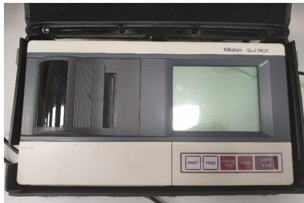
Ilustración 27. Rugosímetro utilizado para las mediciones de las probetas.
