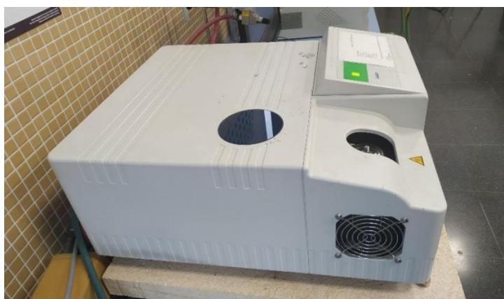
Ilustración 16. Equipo utilizado para la realización del DSC.
