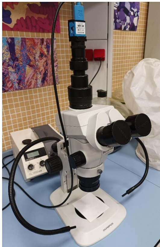
Ilustración 31. Microscopio Estereoscópico Olympus SZX 7.
