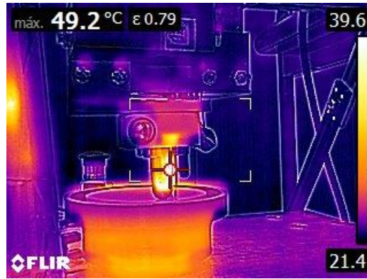
Ilustración 30. Imagen térmica de las temperaturas alcanzadas en la zona de ensayo tras añadir ventiladores a la máquina.
