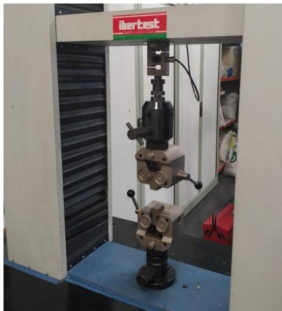
Ilustración 19. Máquina utilizada para el ensayo de tracción.
