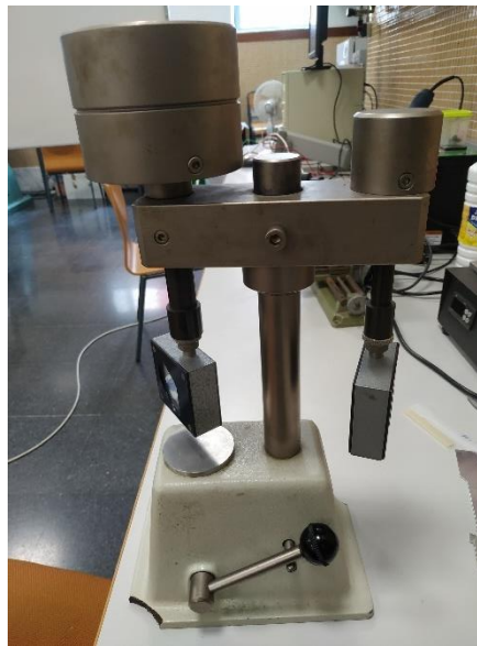
Ilustración 17. Equipo utilizado para el ensayo de dureza.
