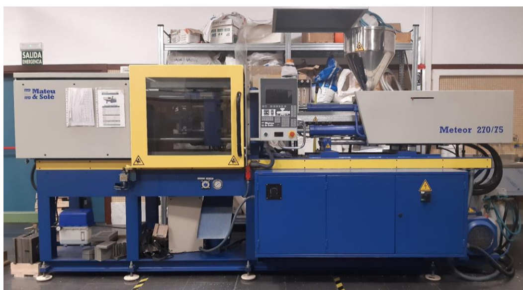
Ilustración 13. Máquina de inyección Meteor 275/270 utilizada para la fabricación de las probetas de este proyecto.
