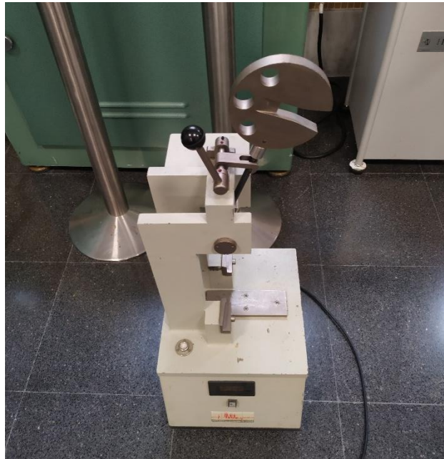
Ilustración 18. Equipo utilizado para el ensayo Charpy.
