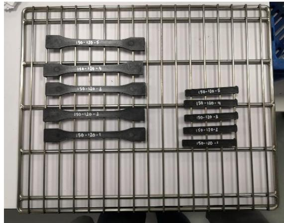
Figura 14. Muestras preparadas para ser tratadas térmicamente
