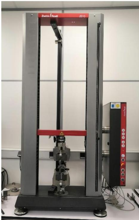
Figura 17. Máquina Universal de ensayos Z010TH de Zwick and Roell
