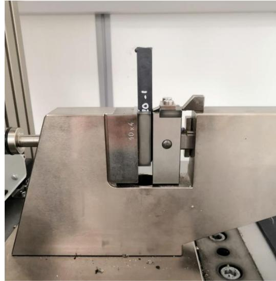
*Figura 20. Posicionamiento de la probeta según el método Izod*
