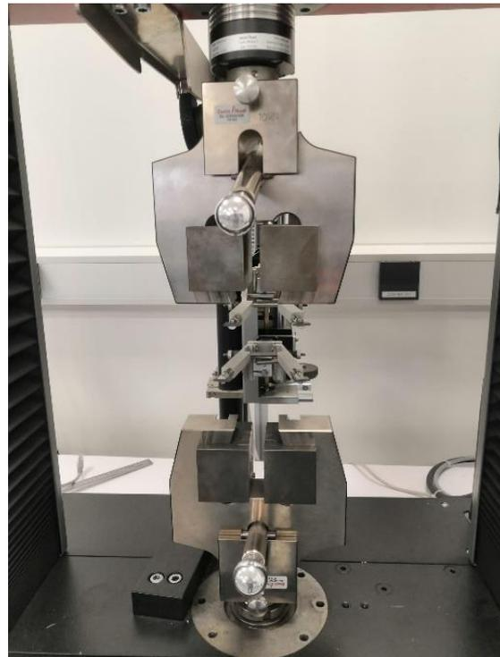
Figura 18. Mordazas y extensómetros de la máquina universal de ensayos
