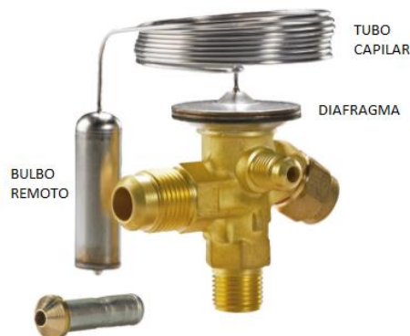
FIGURA 1.52: Válvula de expansión termostática TC-1 Danfoss
