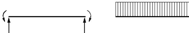
Figura 2. Viga con momento flector constante
