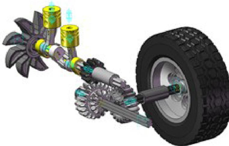
Figura 241. Mecanismo espacial motor vLTm 42049-1.
