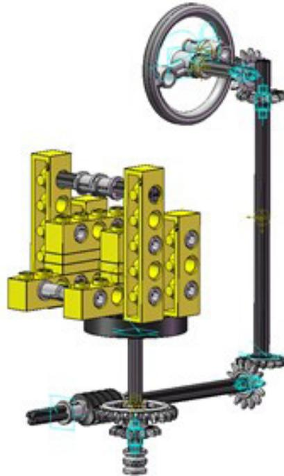
Figura 228. Mecanismo espacial giro retroexcavadora vLTm 8862-1.
