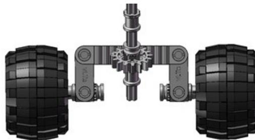
Figura 205. Mecanismo plano dirección vLTm 8816-1.
