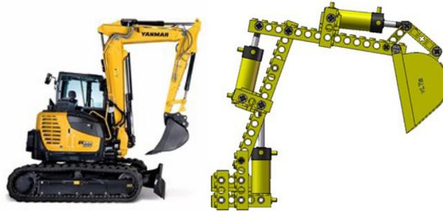
Figura 10. Aplicación de cilindro hidráulico en cuadrilátero articulado equiparable.
