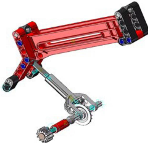
Figura 235. Mecanismo espacial elevación telehandler vLTm 42061-1.
