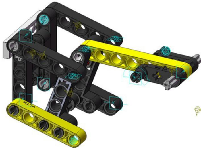
Figura 245. Mecanismo espacial elevación grabber vLTm 42049-1.
