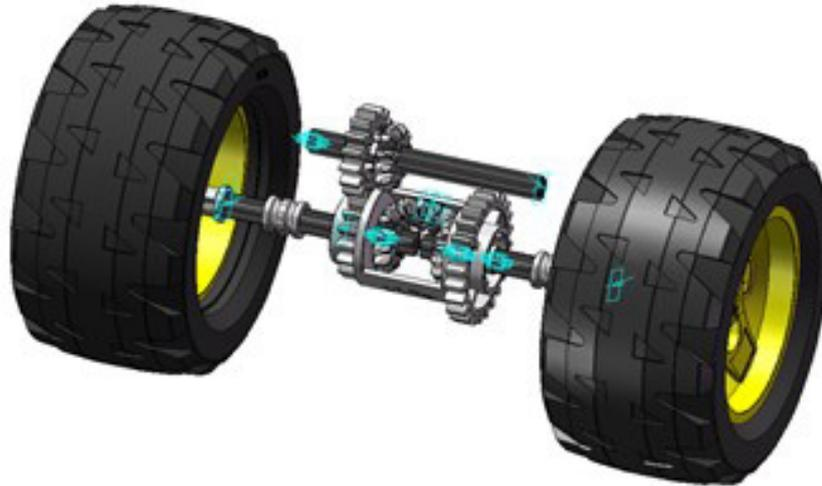
Figura 216. Mecanismo espacial transmisión vLTm 8459-2.
