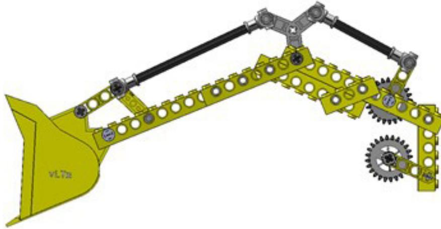
Figura 221. Mecanismo plano pala delantera vLTm 8862-1.
