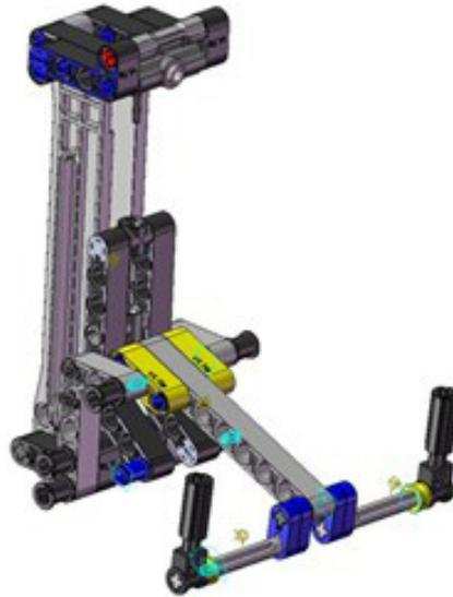
Figura 250. Mecanismo espacial inclinación carretilla vLTm 42079-1.
