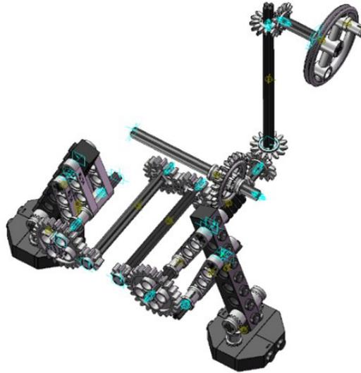
Figura 229. Mecanismo espacial apoyo retroexcavadora vLTm 8862-1.
