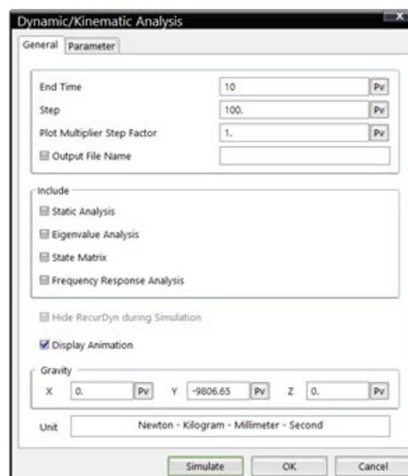
Figura 114. Parámetros simulación RecurDyn.
