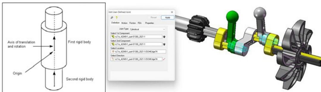
Figura 52. Par cilíndrico CosmosMotion.
