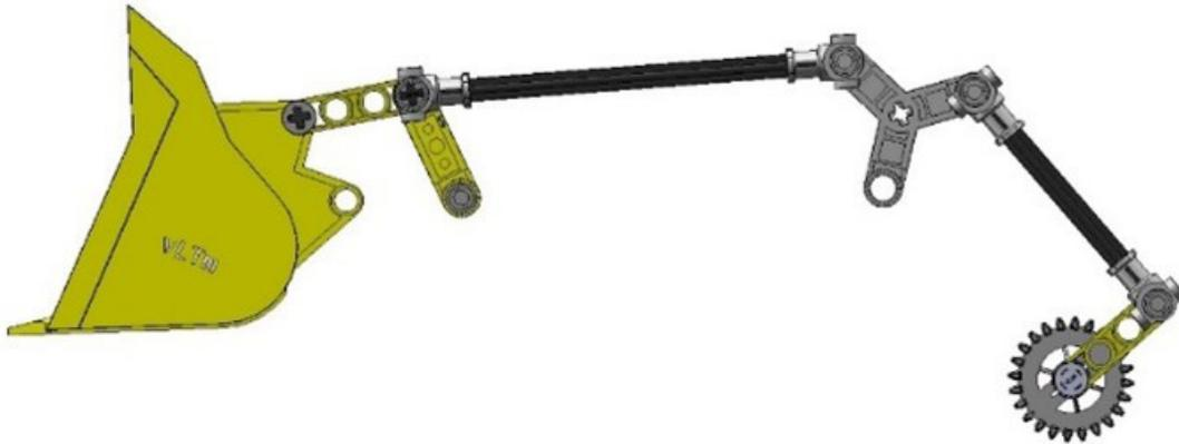
Figura 224. Mecanismo plano inclinación pala delantera vLTm 8862-1.
