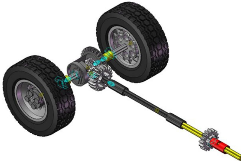
Figura 254. Mecanismo espacial transmisión vLTm 42079-1.
