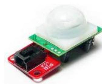
*Ilustración 7: Sensor de movimiento*
