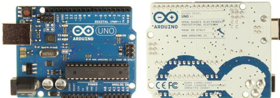
*Ilustración 1: Frontal y reverso de la placa Arduino Uno*
