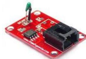
*Ilustración 9: Sensor de temperatura*
