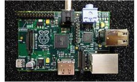
*Ilustración 24: Placa Raspberry Pi*
