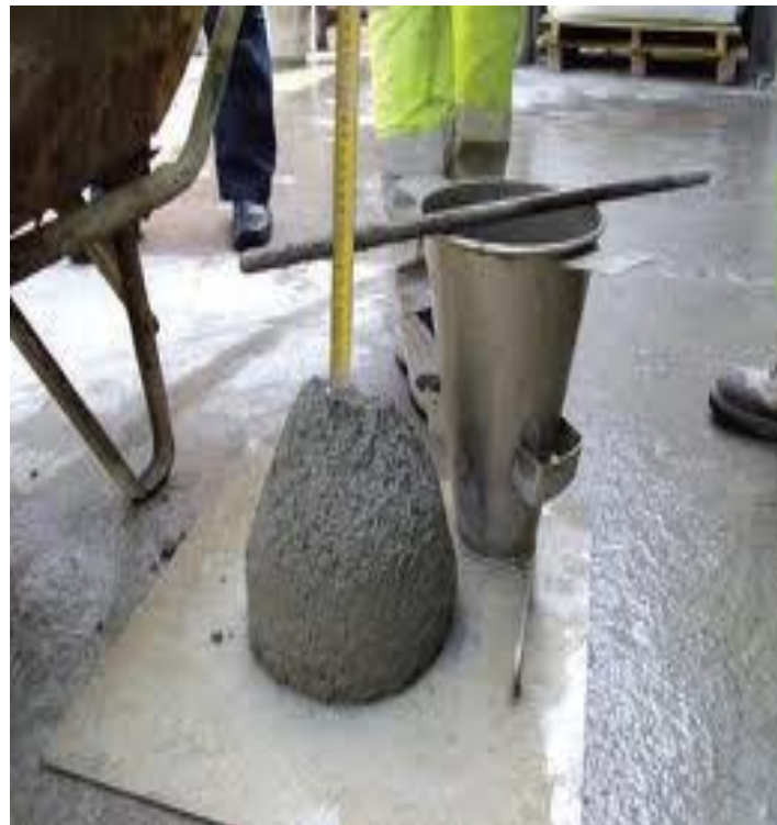
Foto nº 4 – Ensayo de consistencia del hormigón mediante cono de Abrams. Fuente: propia.
