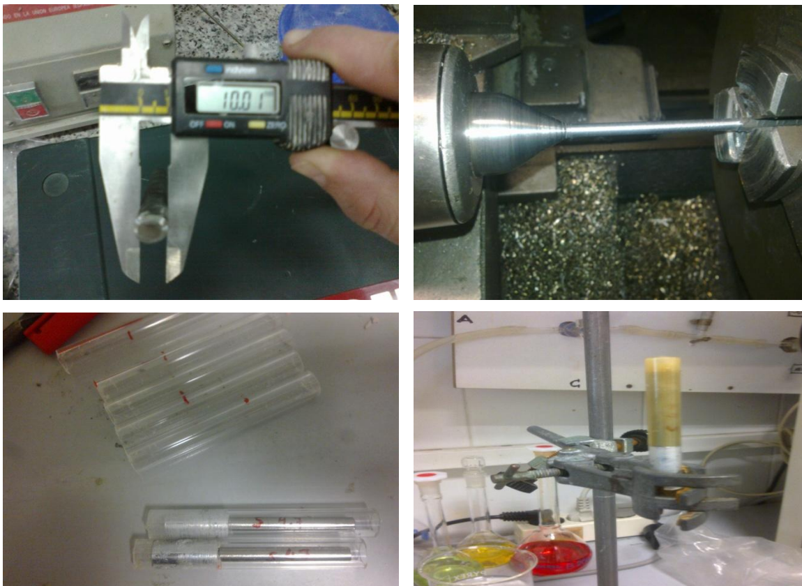
Foto nº 10 – Diversas fases de la fabricación de los electrodos. Fuente: Jose Manuel Gandía Romero.
