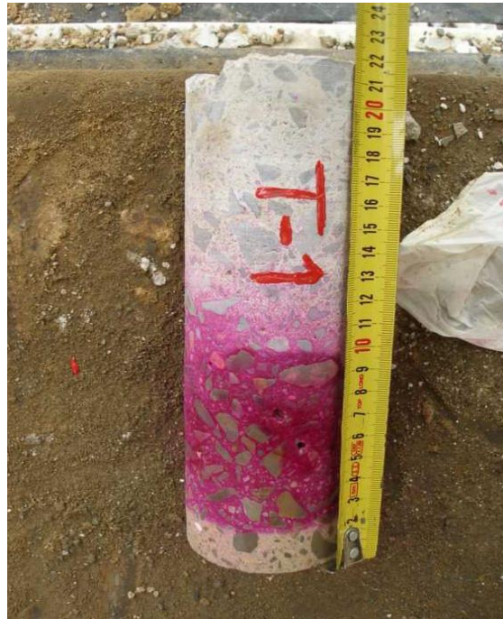
Foto nº 6 – Ensayo de profundidad de frente carbonatado con aplicación de fenolftaleína. Fuente: http://www.ingenierodelacrisis.wordpress.com
