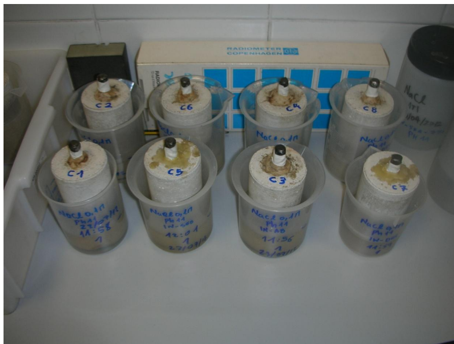
Foto nº 17 – Probetas de ensayo embebidas en disolución. Fuente: propia.
