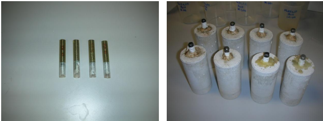
Foto nº 12 – Electrodo y probetas preparadas para los ensayos. Fuente: propia.
