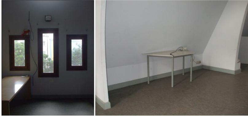
Figura 20. Situación de las sondas. En la primera imagen, las sondas toman datos de la superficie interior de la fachada, y en la segunda las sondas miden la temperatura ambiente.
