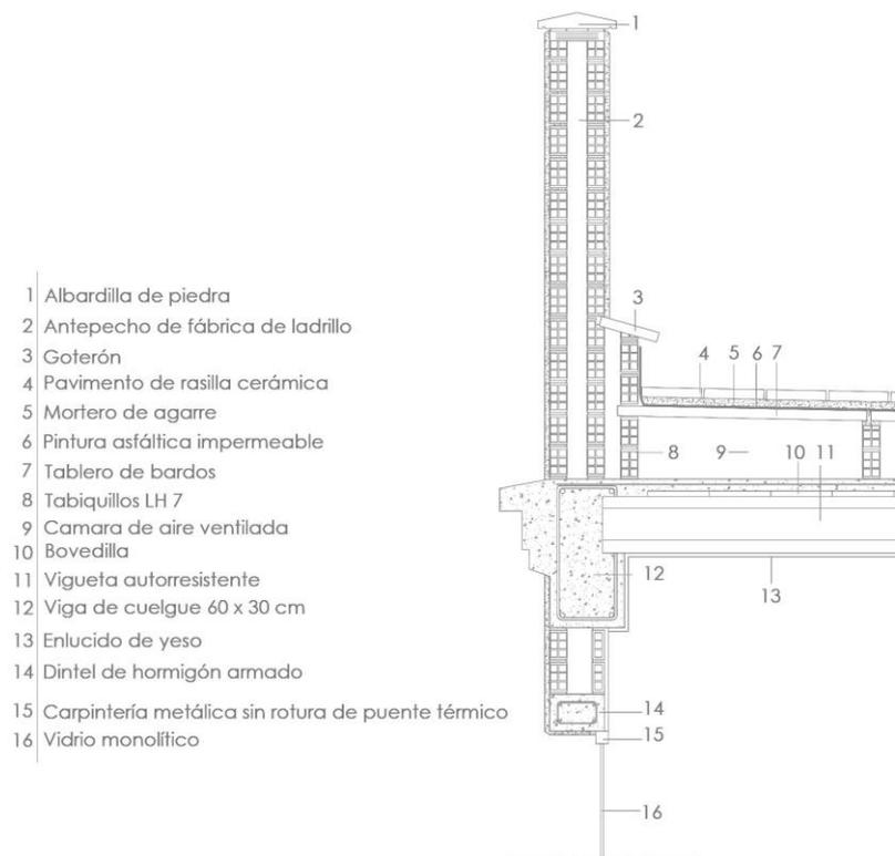
En la resistencia térmica de este sistema solo participa el forjado unidireccional de viguetas y bovedillas de 30 cm. Todas las capas por encima de la cámara de aire se desprecian, ya que esta posee la condición de ser muy ventilada.
