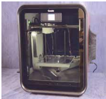
Figura 7. Impresora 3D CocoJet, de la empresa 3D Systems. Fuente: http://pichicola.net/cocojet-3d-imprime-piezas-de-chocolate-en-3d/
