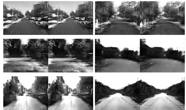
Figura 3: Pares de frames sintéticos, resultado de la salida de nuestro Generador. Pueden observarse caminos en el centro de la escena, y un ligero desplazamiento entre imágenes del par que se corresponde con el movimiento de la cámara.
