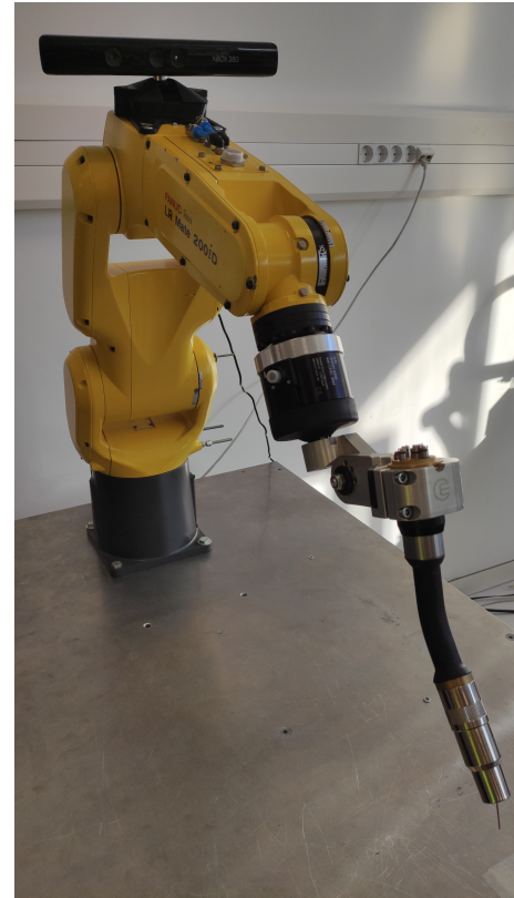
Figura 5: Robot Fanuc LR Mate 200 iD, con la cámara Kinect 360 instalada en su parte superior, y una antorcha de soldadura en el efector final
