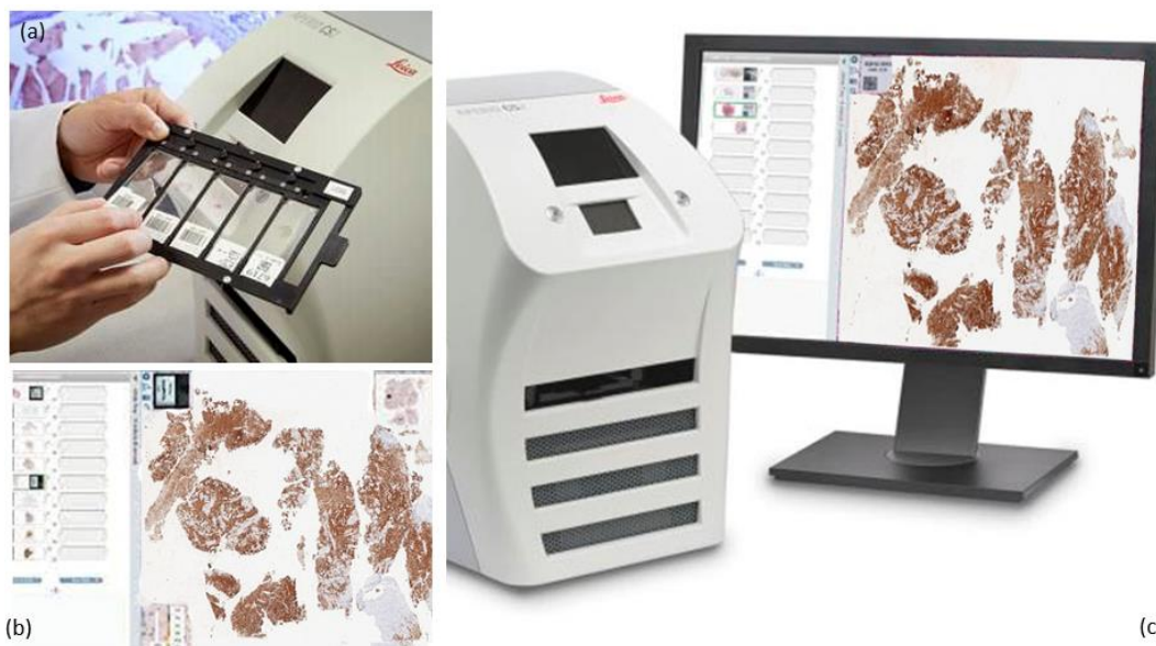
Figura 3.1: (a) soporte para los portaobjetos analógicos, (b) Interfaz del software Aperio ImageScope y (c) Escáner Aperio CS2. Imagen modificada de la referencia [46].
