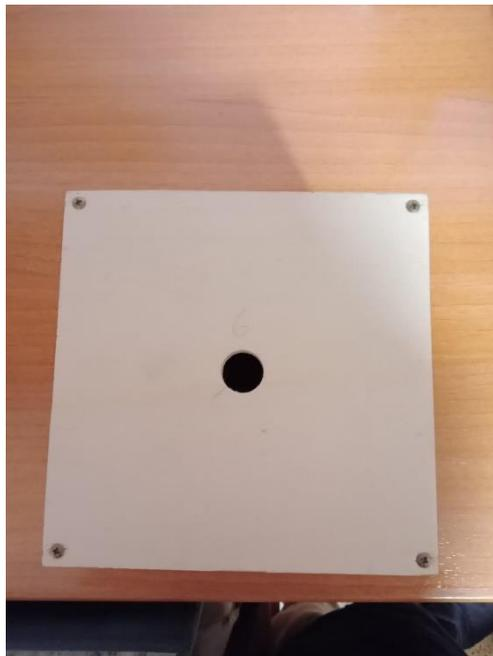
**Figura 11.** Imagen cenital de la cámara oscura mostrando el orificio de un diámetro similar a los trocares usados en laparoscopia.
