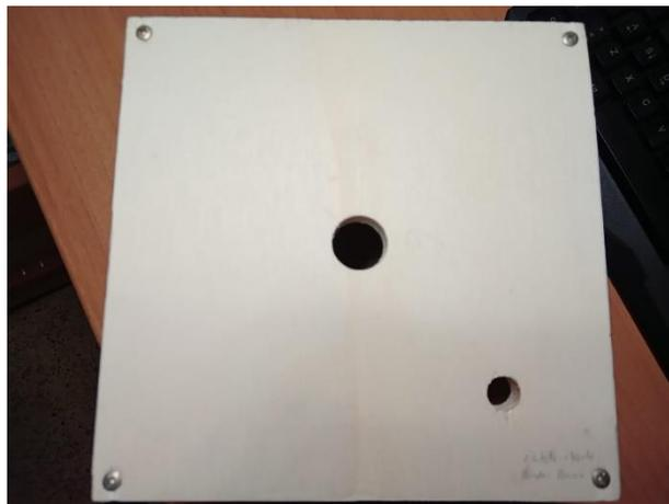
**Figura 21.** Imagen cenital de la cámara oscura mostrando el orificio accesorio para la introducción de una fuente de luz de laparoscopia.
