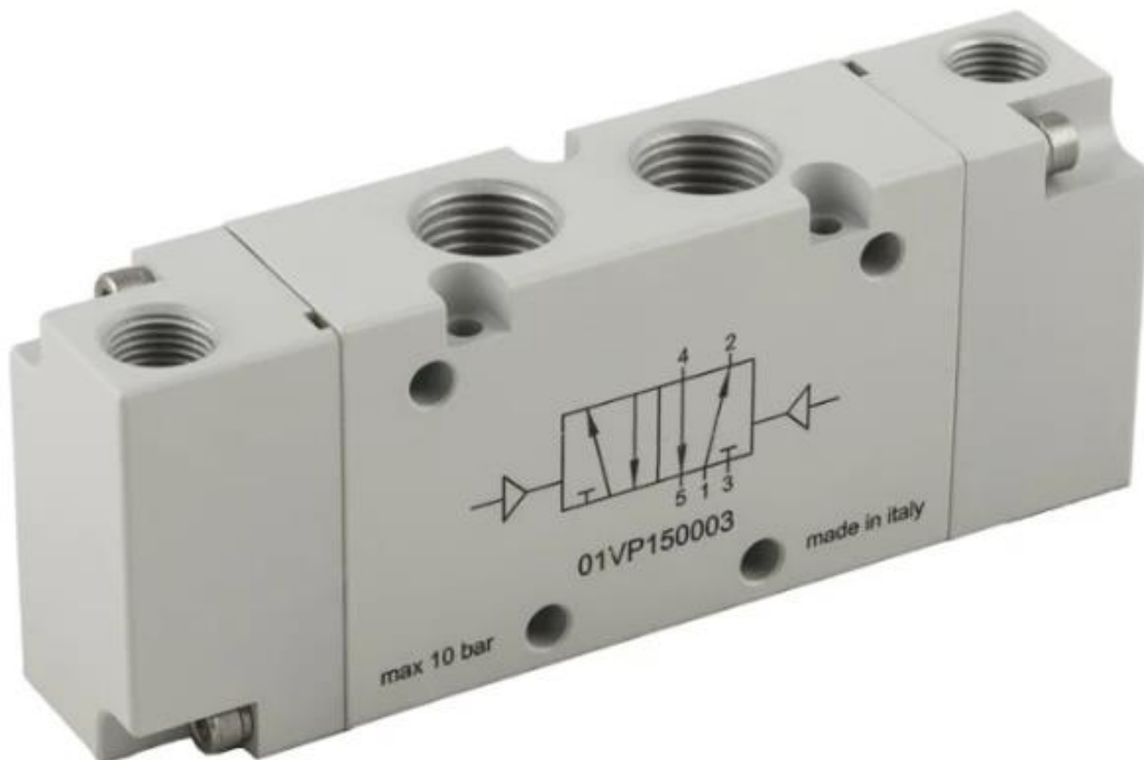
ILUSTRACIÓN 107: ELECTROVÁLVULA MONOESTABLE 5/2.
