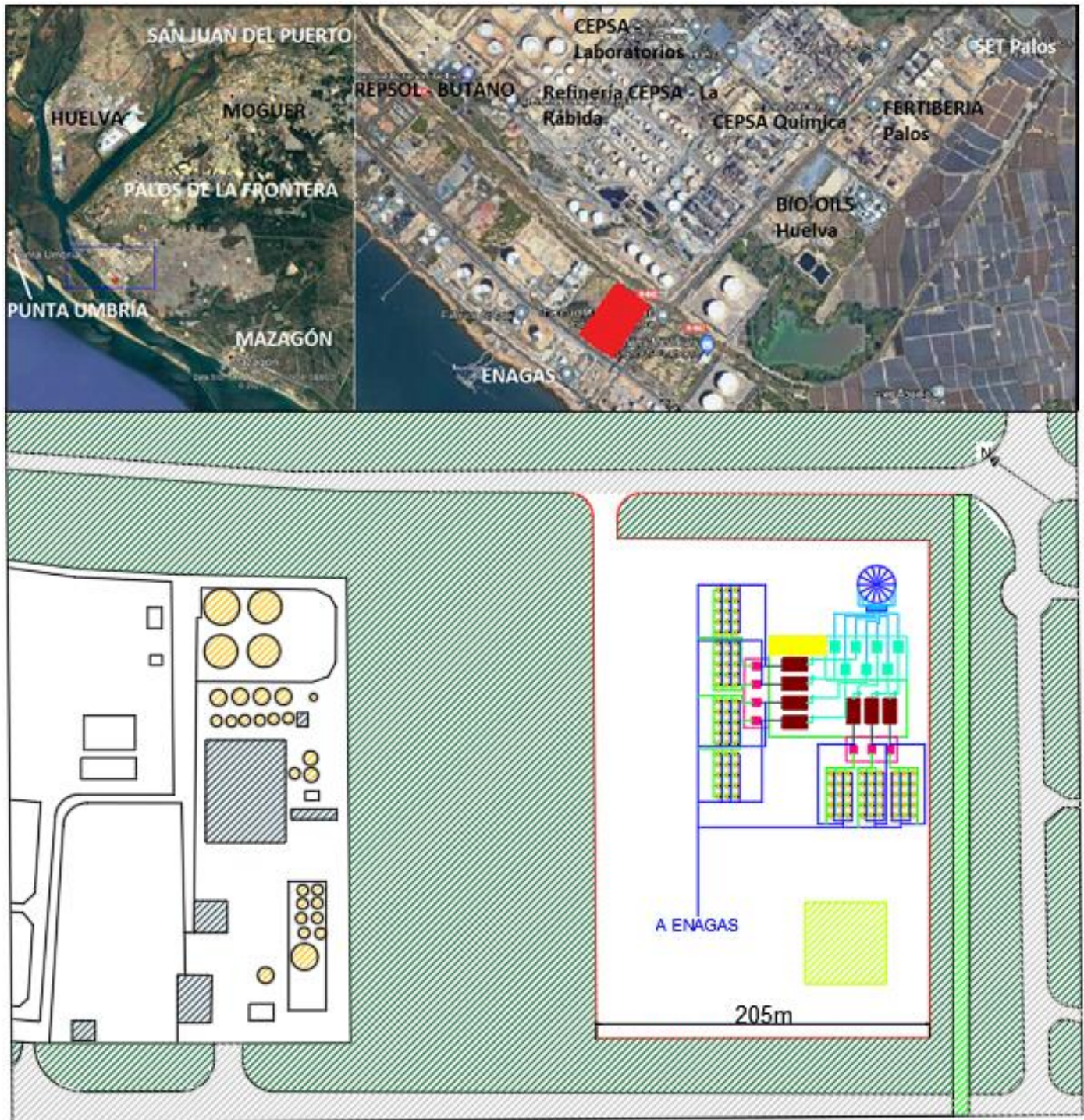
Figura 12. Mapa de municipios, núcleos poblacionales colindantes, Polígono Industrial de Nuevo Puerto y representación esquemática de la planta de electrólisis en la parcela. Todas las dimensiones del esquema se encuentran en proporción con las dimensiones reales de los dispositivos y estructuras. A modo orientativo se ha indicado la longitud del ancho real de la parcela.
