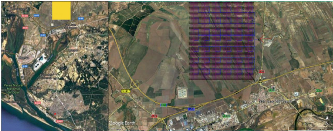
Figura 25. Posición relativa entre la central PV (representada mediante un cuadrado amarillo) y la planta de electrólisis (representada mediante un rectángulo rojo). En la parte derecha se ha representado de forma esquemática la distribución de los paneles PV, CTMT y SET (color negro) y de los trazados de las líneas de AC de BT (color lila) y de los trazados de las líneas de MT (color azul). La flecha roja indica la ubicación de la SET y punto de acceso a la central PV.
