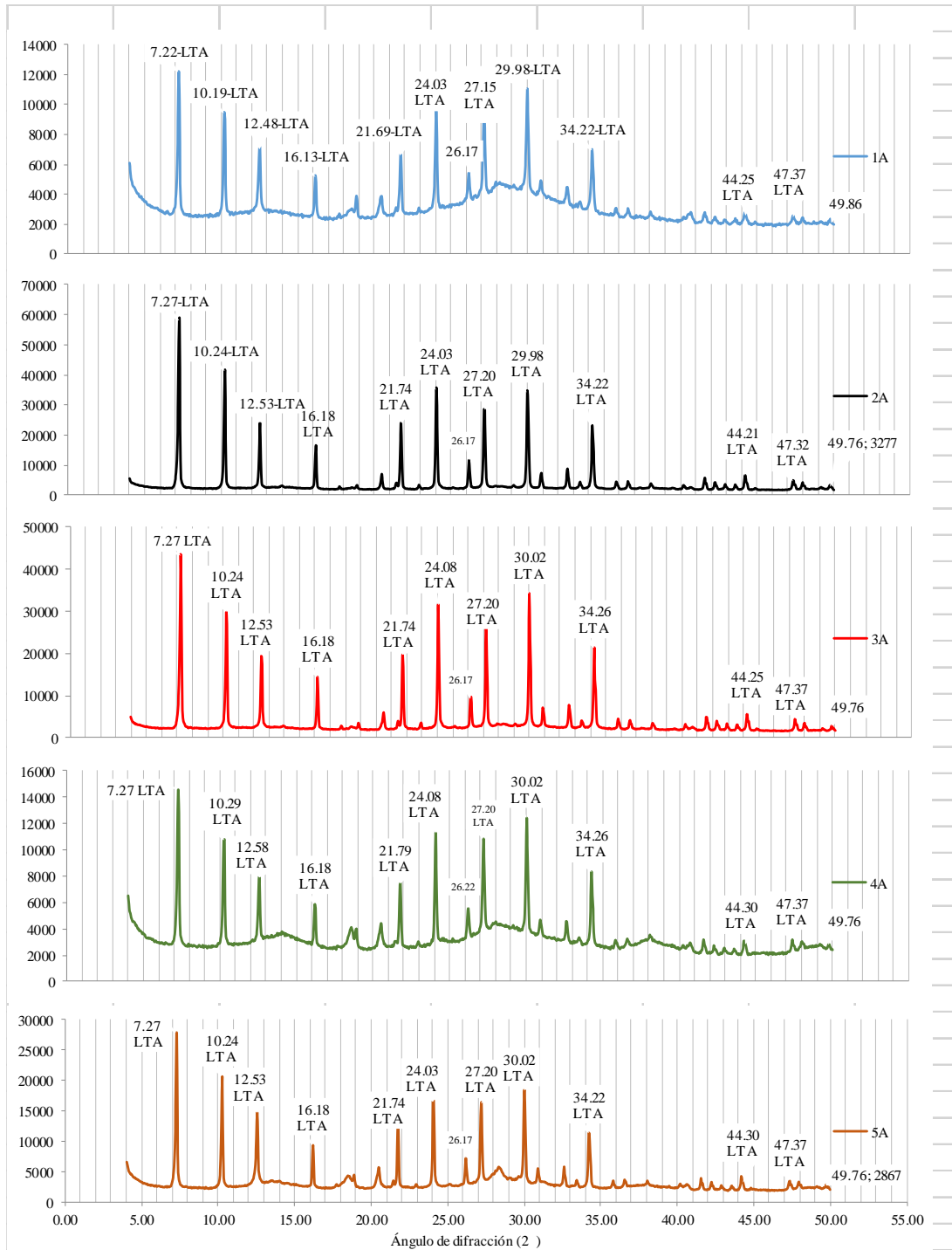
Figura 6.57. Comparación de los difractogramas XRD de los materiales obtenidos 1A, 2A, 3A, 4A y 5A, respectivamente de arriba hacia abajo (composición detallados en la tabla 5.4). Se indican los picos principales asignables a la zeolita tipo LTA.
