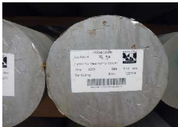
Figura 1. Aluminio 6063 aleación de aluminio-silicio-magnesio (Fotografía tomada en planta con autorización de la Empresa)
