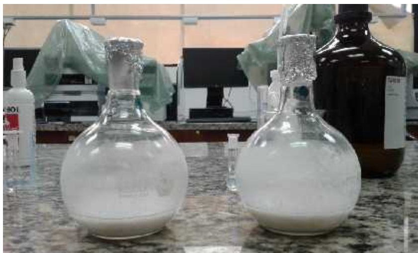
Figura 5.8. Balones pírrex parte del reactor conteniendo el gel de síntesis de la zeolita LTA
