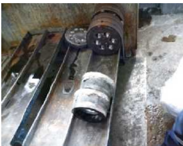
Figura 2. Matrices de acero utilizadas para la extrusión de los lingotes de aluminio, que luego de varias operaciones quedan impregnadas de escoria de aluminio (Fotografía tomada en planta con autorización de la empresa)
