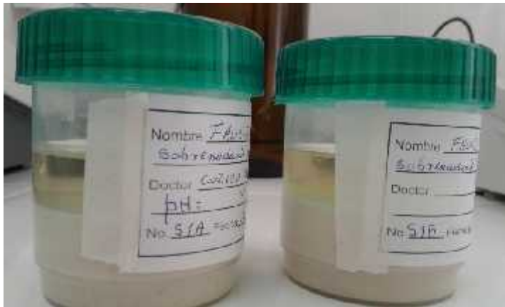
Figura 5.9. Sobrenadante y zeolita luego del centrifugado con agua destilada.
