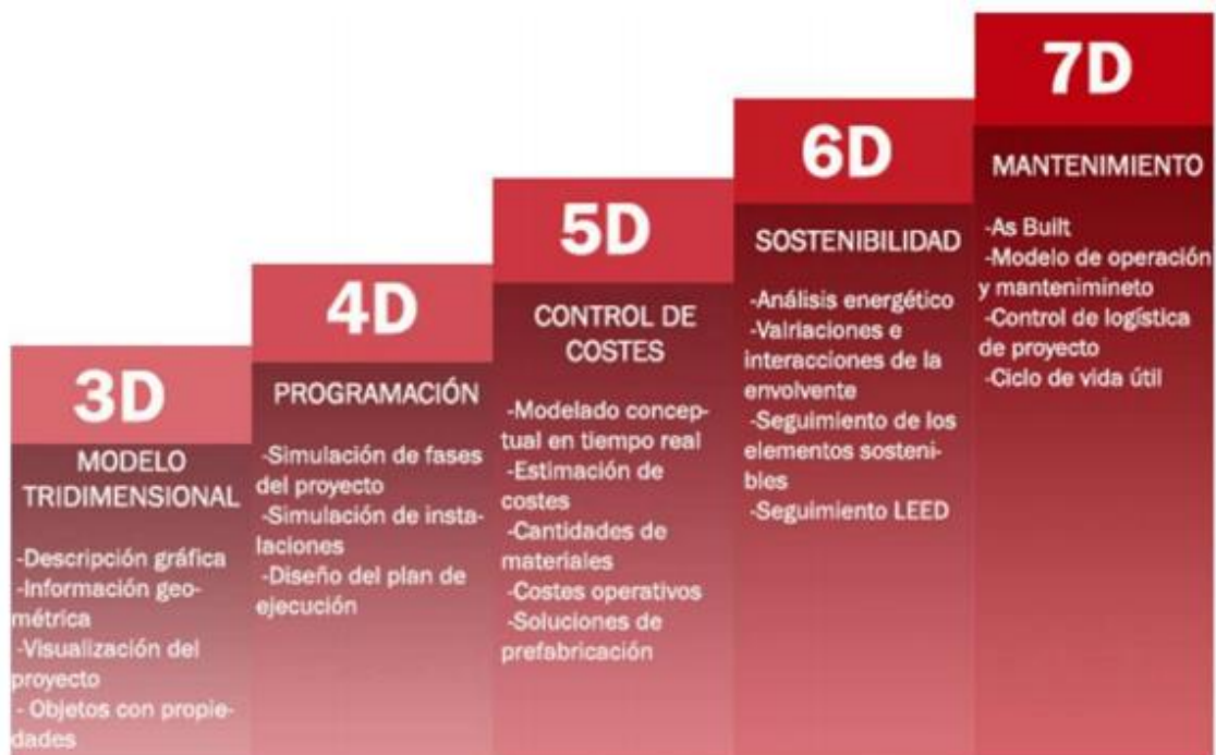
Figura 3. Dimensiones BIM. Fuente: Apuntes asignatura de BIM
