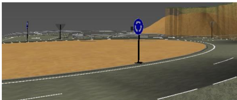
Figura 81. Ejemplo señalización horizontal en glorietas
