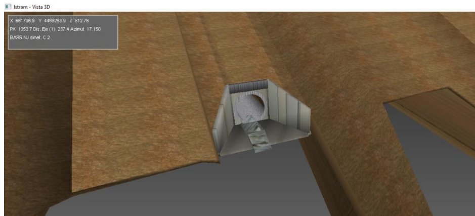
Figura 59. Desagüe de la ODT 4-4
