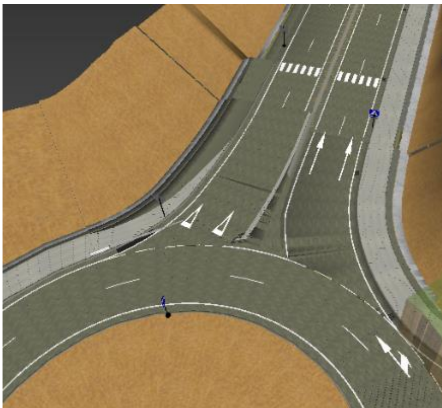
Figura 79. Ejemplo de señalización horizontal
