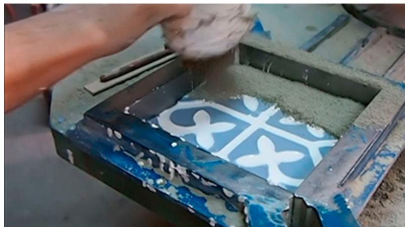
*Imagen 6. Capa secante antes de colocar el cemento.*
