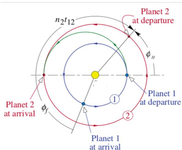
**Figura 5:** Maniobra de rendezvous desde una nave (1) en órbita interior hasta otro (2) en órbita exterior
