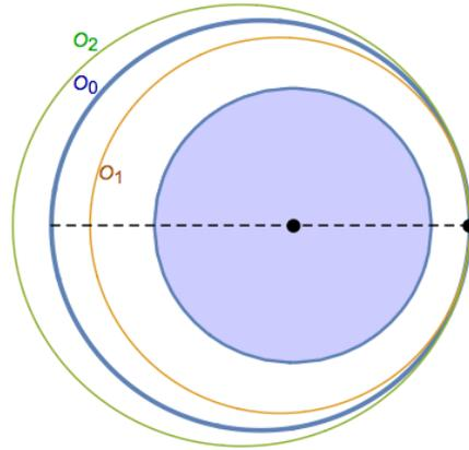
**Figura 1:** Para ajustar la posición dentro de una órbita se utiliza una maniobra de ajuste de fase con órbitas de transferencia más cortas o más largas según interese
