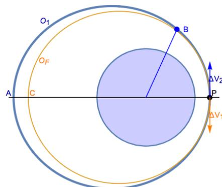
**Figura 2:** Maniobra de ajuste de fase para adelantar la posición del móvil en su órbita. Es necesaria una órbita de fase más corta.
