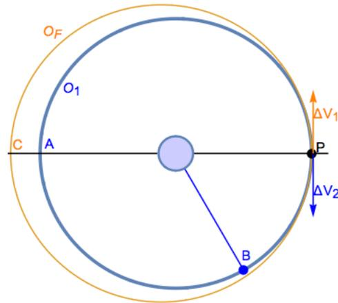
**Figura 3:** Maniobra de ajuste de fase para retrasar la posición en una órbita
