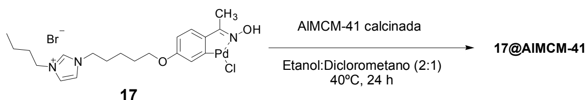
Esquema 7.2. Procedimiento de adsorción del compuesto 17 en AIMCM-41
