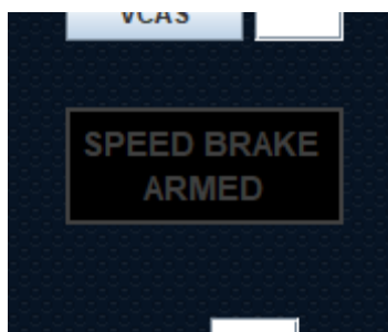
Figura 22: Indicador SPEED BRAKE ARMED desactivado
