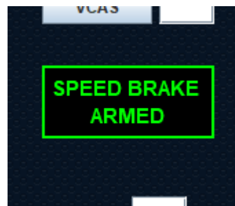
Figura 23: Indicador SPEED BRAKE ARMED activado
