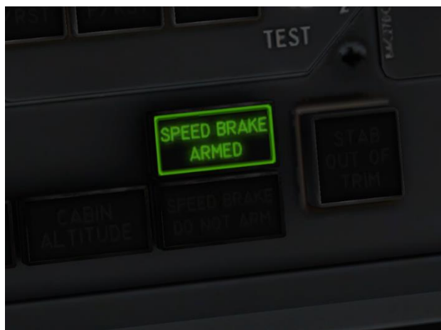
Figura 6: Indicador SPEED BRAKE ARMED de un Boeing 737 activado en el simulador X-Plane
