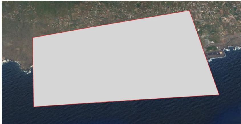
Ilustración 38. Superficie con pendiente igual a la pendiente de frustrada, situada 50 m por debajo del procedimiento.
