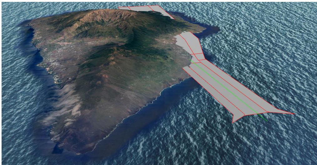
Ilustración 52. OAS APV-BARO en La Palma. VPA de 3,5° y procedimiento desplazado 15°.
