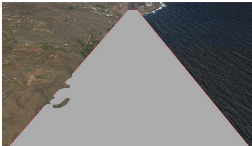
Ilustración 44. VSS para la aproximación APV-BARO con VPA de 3^\circ en La Palma.
