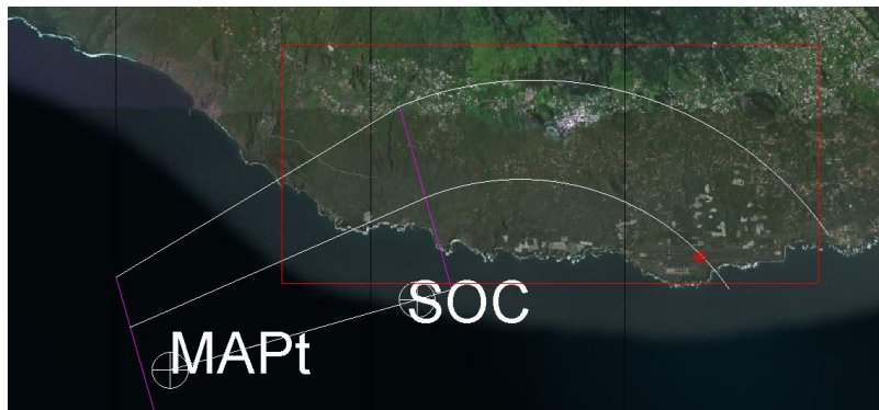
Ilustración 66. En rojo, zona afectada por obstáculos en el viraje de aproximación frustrada.
