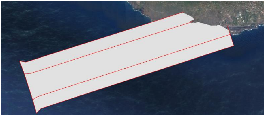
Ilustración 61. Aproximación final, procedimiento LNAV desplazado 15°.
